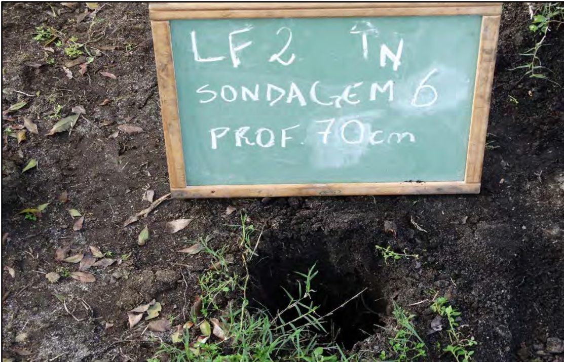
Figura 35: Sondagem número 6 apresentando a maior profundidade entre os poços teste perfurados. Foto do autor
