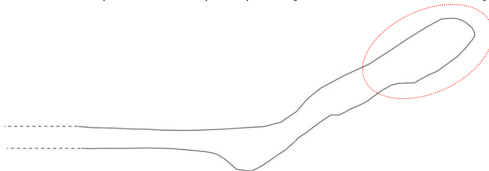
Imagem 18 – Perfil esquemático de um prato tipo reforçado. Em vermelho, borda reforçada.
