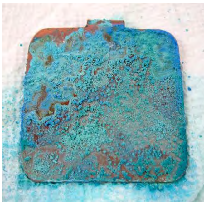
Figura 15 – Placa de metal coberta por pátina na coloração verde em praticamente toda a superfície do artefato
