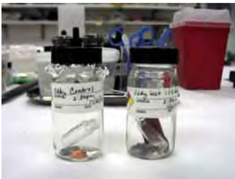
Figura 16 – Exemplo de Test Oddy para determinar se o material vai liberar sulfetos voláteis ou ácidos
