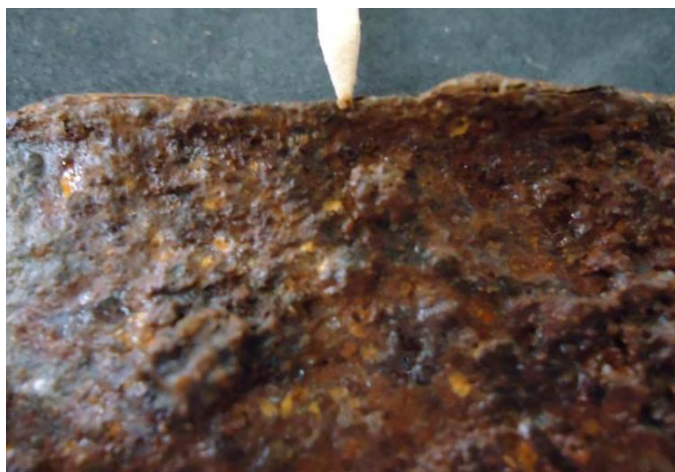
Figura 46 – Aparecimento das gotículas de corrosão ativa Fonte: ACERVO LÂMINA.
