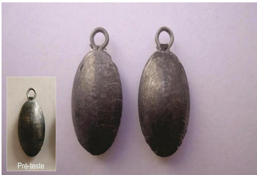
Figura 66 – Chumbo sem o TNT (à esquerda) e chumbo mantido com TNT (à direita) Fonte: ACERVO PESSOAL, 2015.
