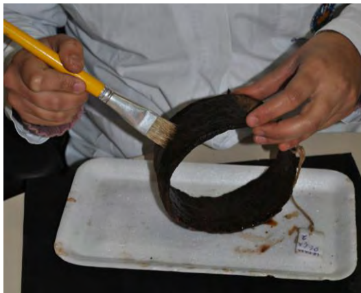
Figura 16: Aplicação de ácido tânico Fonte: BDL
