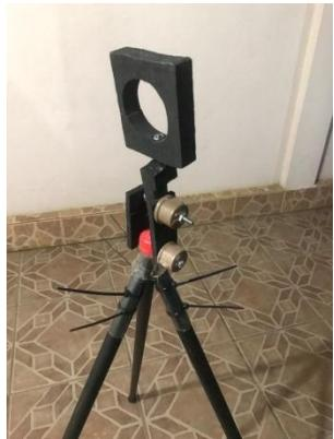
6. Para finalizar, posicione o telescópio no suporte e posicione a lente ocular na outra ponta.
