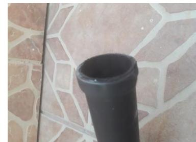
3. Encaixe a parte do tubo de 40 mm sem a fita dupla face na extremidade do tubo de 50 mm também sem a fita dupla face. Deste modo, um tubo irá correr dentro do outro.
