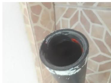
2. Preencher um dos lados exteriores do tubo de PVC de 40 mm com a fita dupla face
