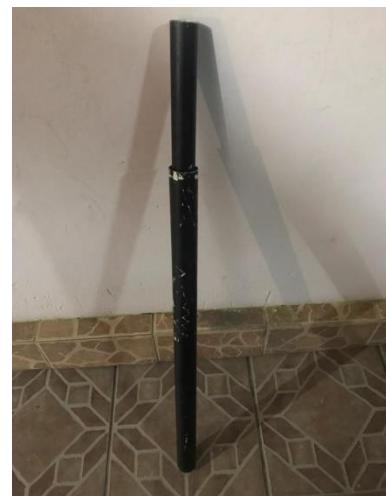
4. Encaixa a lente objetiva na extremidade do tubo de 50 mm com cola quente.
