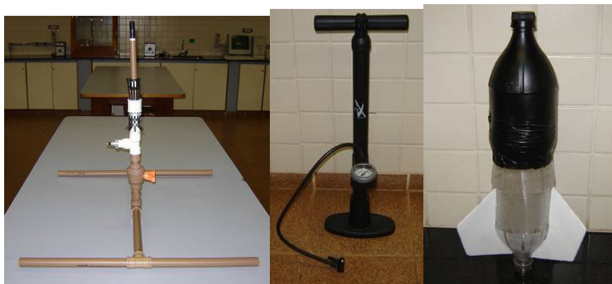
Figura 2: Disparador, bomba de ar com manômetro e o foguete de pet
