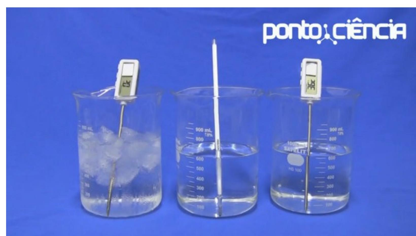
A figura acima mostra três recipientes com água. O primeiros com água gelada, o segundo com água em temperatura ambiente e o terceiro com água aquecida.
