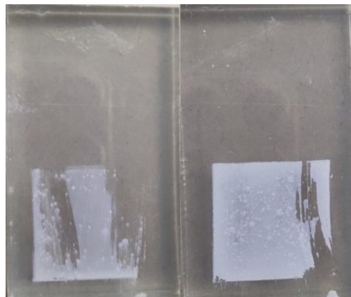
Figura 26 – Testes de temperatura a 500 °C com DDP de 1,5 V e 3,0 V (da esquerda para direita) em filmes com 16 minutos de EDP, para os tempos de sinterização de 30 minutos A) sinterizado e B) pós teste de aderência, 1 hora em C) sinterizado e D) pós teste de aderência e com 2 horas em E) sinterizado e F) pós teste de aderência.
