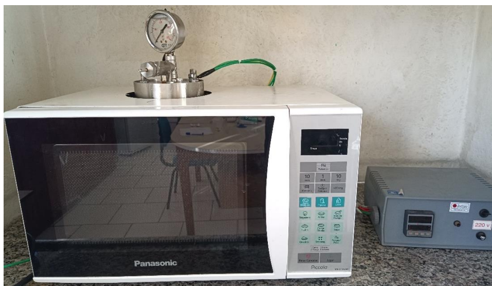
Figura 12: Micro-ondas utilizado para as sínteses.
