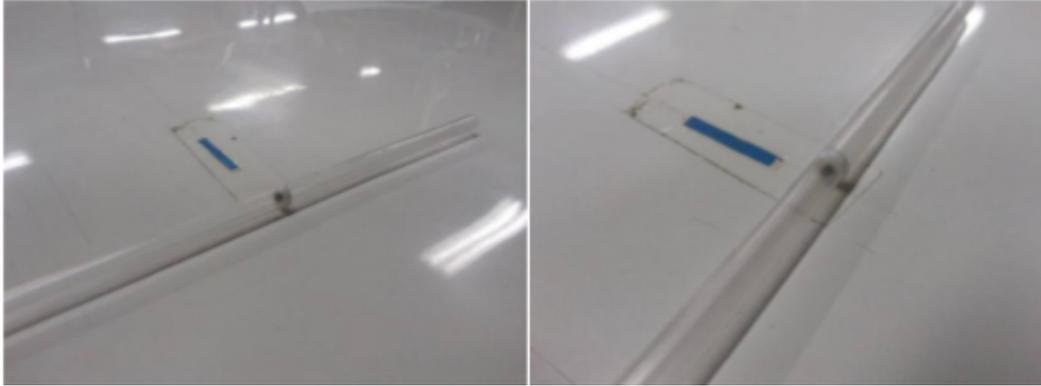
Figura 3.7 - Porta-amstras (disco de teflon com amostra e tubo cilíndrico) preparado para a aplicação de campo magnético ao longo do eixo cristalográfico  $c$  de um monocristal.
