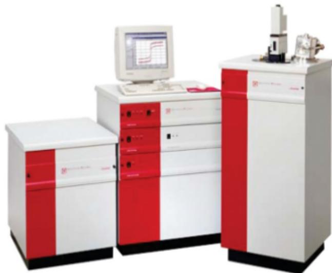
Figura 3.6 - Magnetômetro de SQUID: a imagem da à esquerda corresponde a etapa criogênica, a da parte central corresponde ao sistema de controle do equipamento e à da direita corresponde ao módulo onde é instalada a amostra e são efetuadas as medidas.
