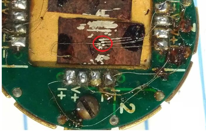
Figura 3.11 - Imagem de um monocristal com os contatos elétricos implementados e instalado no porta amostra (“puck”) do PPMS. Na imagem, para fins de identificação a amostra foi circulada em vermelho.
