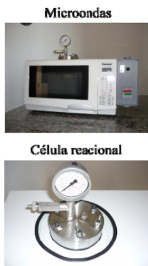
Figura 2.3 - Forno micro-ondas hidrotermal (HAM).
