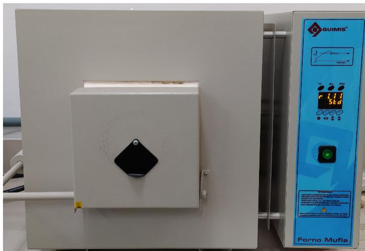
Figura A.3 - Sinterização do filme em forno tipo mufla.
