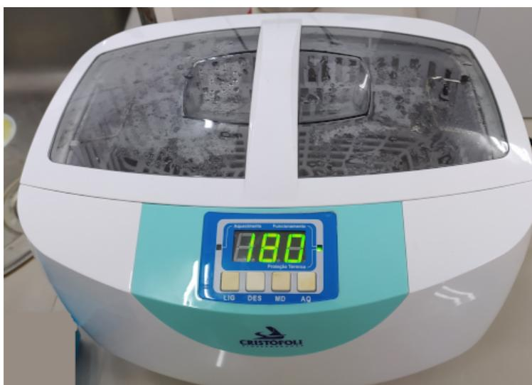
Figura A.1 - Lavagem dos eletrodos em banho de ultrassom.
