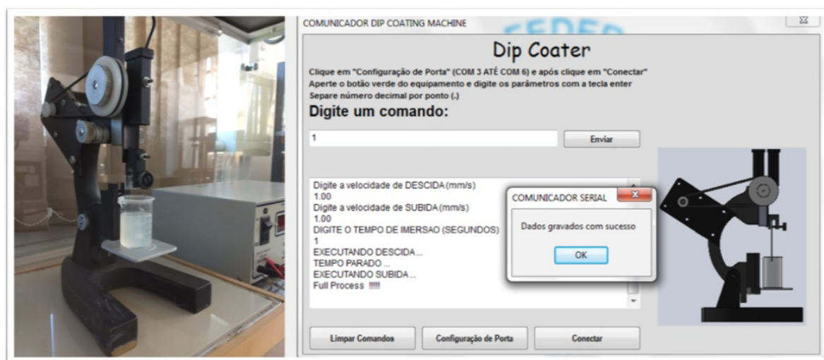
Figura 19 – Foto à esquerda da deposição via dipcoater do sol-gel de alumina em substrato de vidro e à direita foto da interface de inserção dos parâmetros de deposição.
