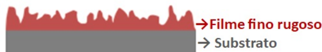
Figura 21 – Ilustração da topografia formada na superfície após o desbastamento químico tirar pedaços do filme.
