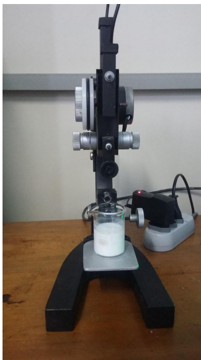
Figura 4.2 - Equipamento de Dip Coating utilizado na deposição dos filmes de Titanato de Bário.
