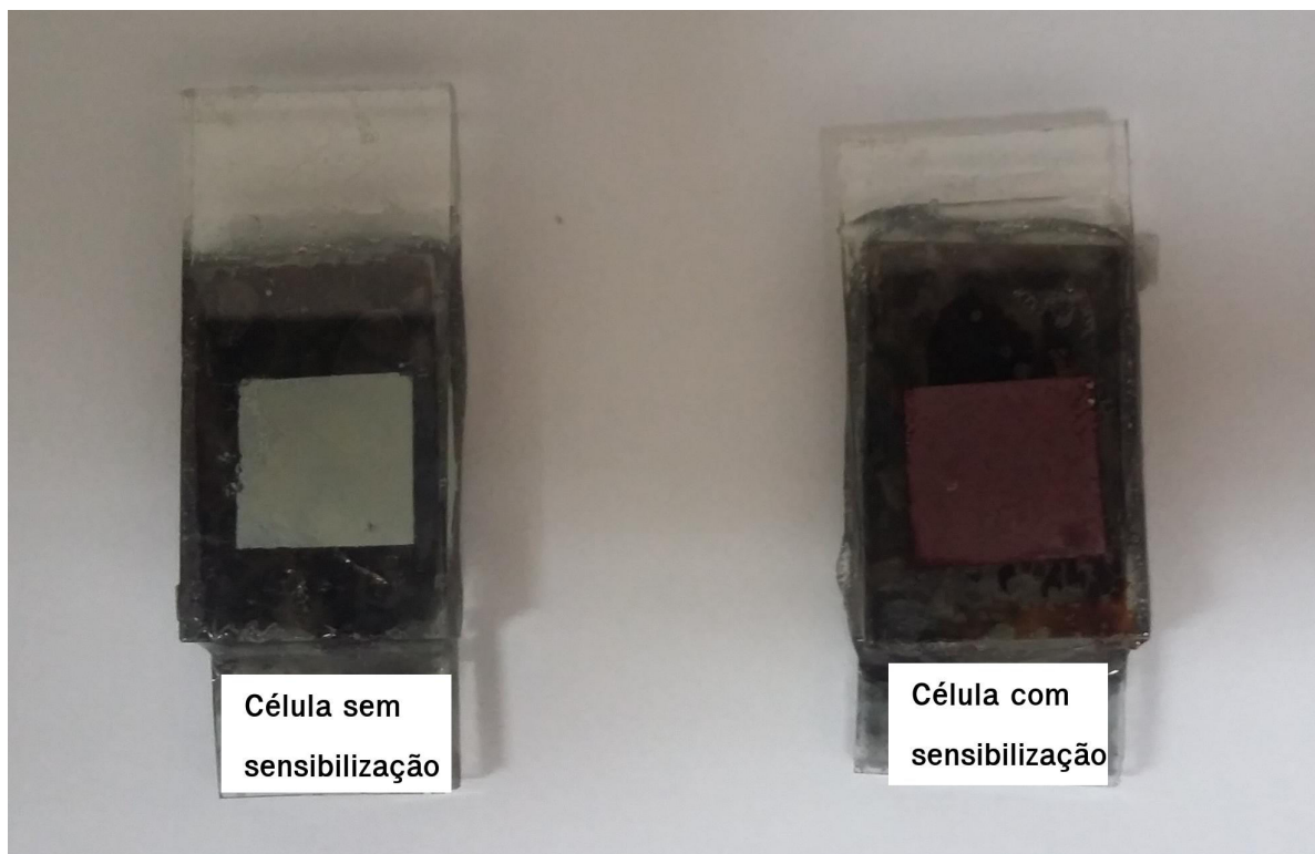
Figura 6.5 - Duas células solares de Titanato de Bário montadas com o eletrólito de iodeto/triodeto de potássio e contra eletrodo de platina.
