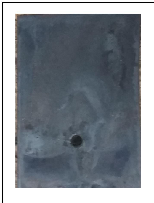
Figura 7.2 - Camada de platina depositada sob o substrato de FTO por meio da decomposição térmica.
