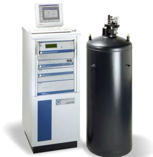
Figura 2.7: Equipamento PPMS ( Physical Properties Measurement System ), modelo 6000, da Quantum Design: à esquerda, os módulos opcionais e controladores e, à direita, a parte criogênica [83].
