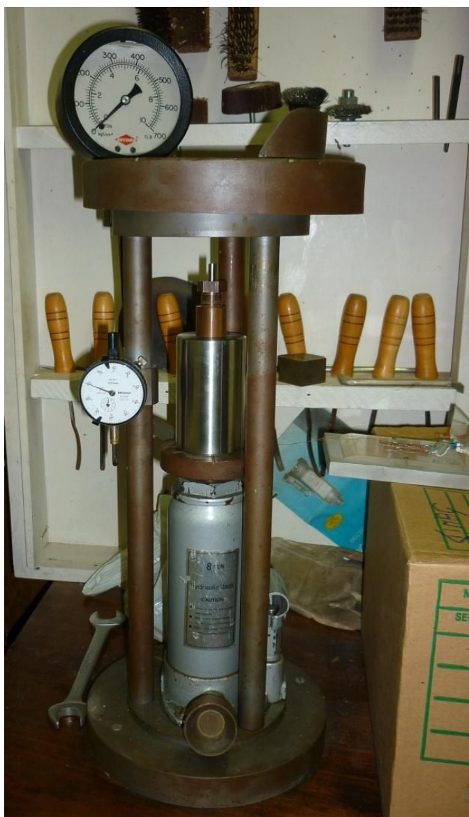
Fig. 2.19: Célula de pressão dentro do suporte de aço inox temperado, posicionada na prensa hidráulica para aplicação de força externa ao sistema.
