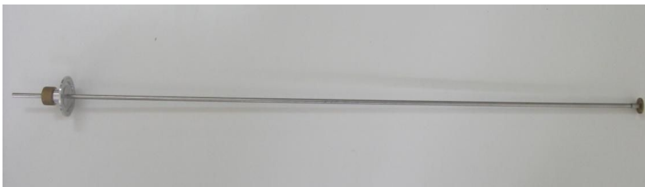
Figura 2.21: Vareta utilizada para a instalação da célula de pressão no interior da câmara da amostra do PPMS.
