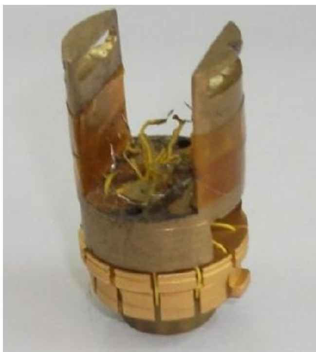
Figura 2.20: Imagem do adaptador que fixa a célula de pressão ao “ puck ”.
