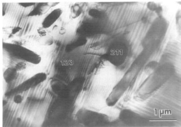
Figura 1.10: Microscopia eletrônica de transmissão para uma amostra texturizada de \text{YBa}_2\text{Cu}_3\text{O}_{7-\delta} [9] , onde é possível visualizar os grãos correspondentes a fase Y123 e Y211.
