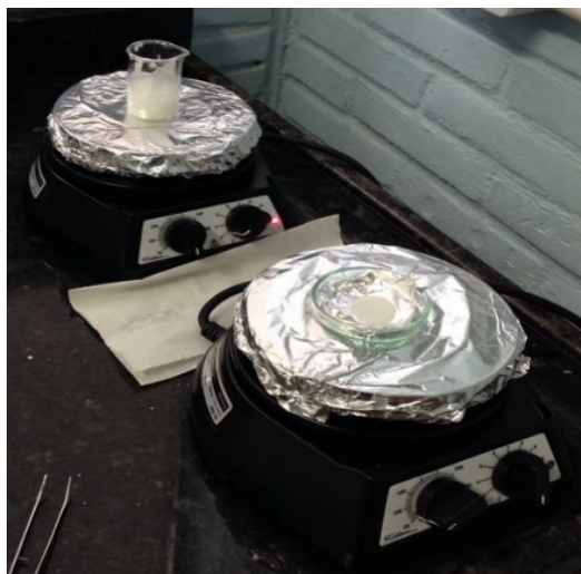
Figura 3.4 - Matriz polimérica de poliamida 6.6 Technyl ® e a solução a base de ácido fórmico, Nylon ® e BZHO em forma de pó, sob placas de aquecimento
