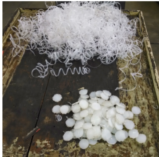
Figura 3.6 - Processo de usinagem da barra de poliamida 6.6, para a obtenção dos substratos com uma espessura de 3 mm e diâmetro de 2,5 cm
