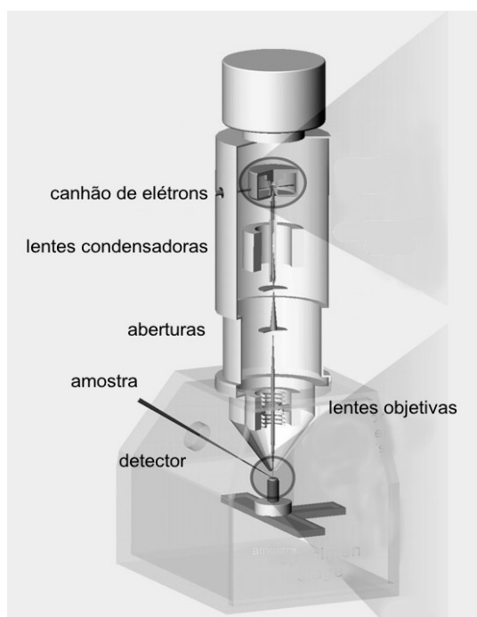
Figura 3.2 – Componentes básicos do microscópio eletrônico de varredura (MEV).
