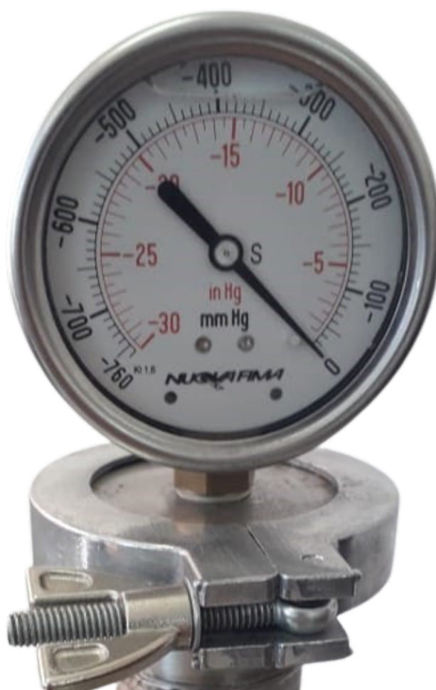
Figura 15 – Vacuometro Nuova Fima. Fonte: Autor.
