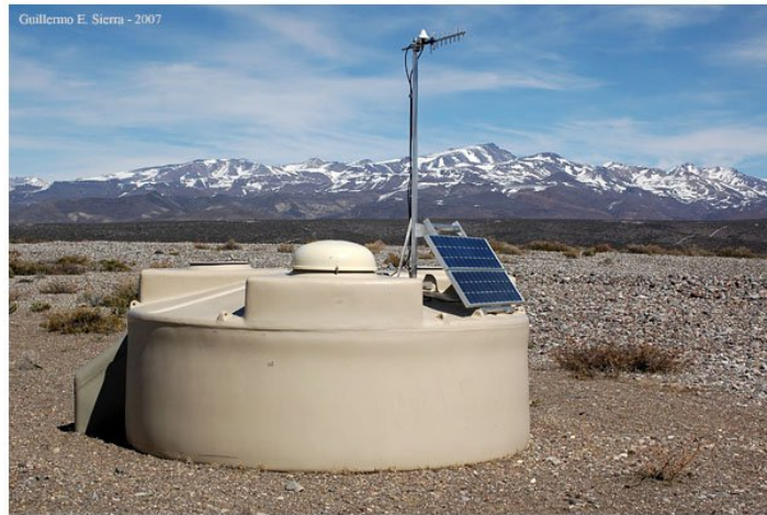
Figura 2.4 - Imagem ilustrativa de um dos tanques de superfície do Observatório Pierre Auger. Dentro do tanque, três fotomultiplicadores detectam a passagem de partículas relativísticas [73].
