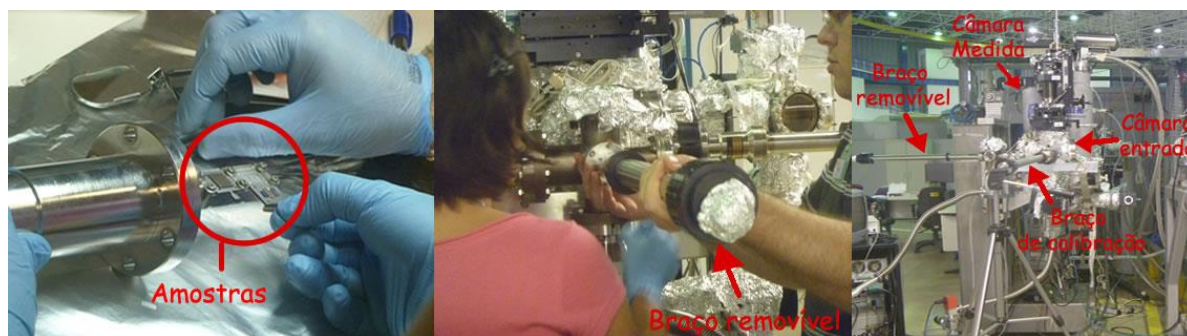
Figura 3.12 - Condicionamento das amostras antes da medição. (a) Fixação das amostras ao braço removível, (b) inserção do braço removível à câmara de entrada, (c) Vista frontal da estação de medida.
