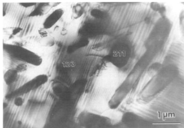
Figura 1.11 - Microscopia eletrônica de transmissão de uma amostra de \text{YBa}_2\text{Cu}_3\text{O}_{7-\delta} , texturizada onde é possível observar grãos correspondentes às fases Y123 e Y211 [19].
