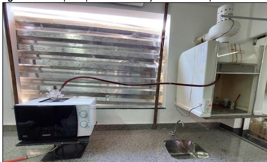
Figura 06: Tampa superior do reator junto com a capela de exastor.
