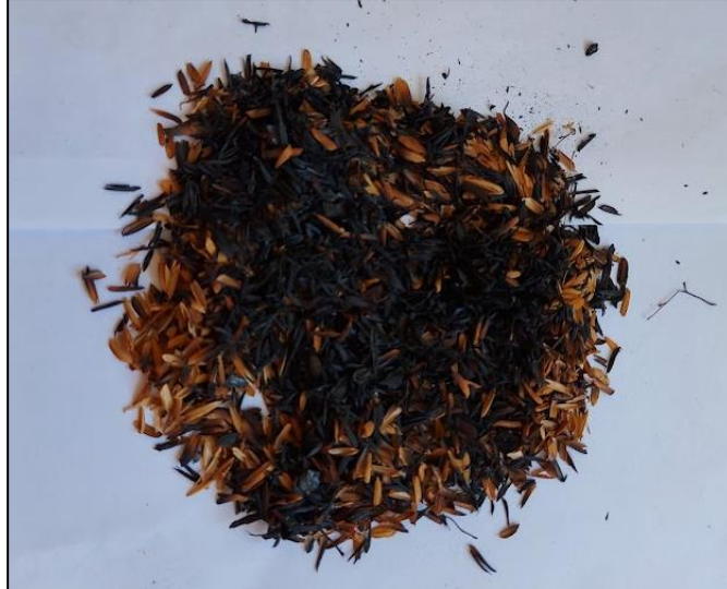
Figura 29: Carvão vegetal produzido com algumas falhas.
