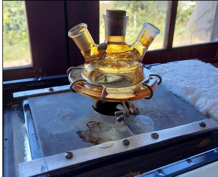
Figura 36: Bio-óleo gerado durante a processo de produção de carvão vegetal.
