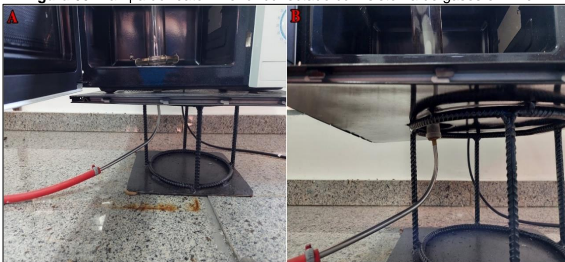
Figura 05: Tampa do reator inferior conectado com sistema de gases em A e B
