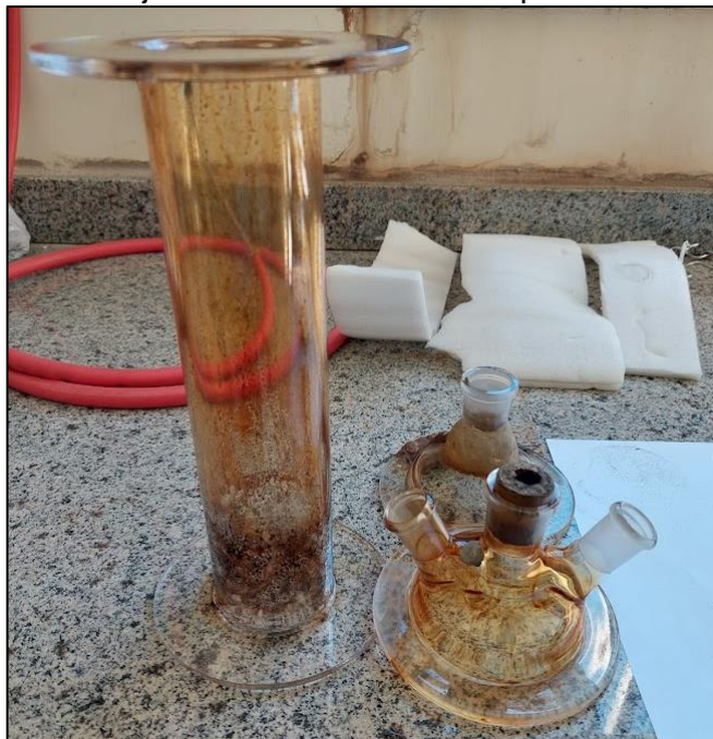
Figura 39: Reator sujo com óleo resultante da queima da casca de arroz.
