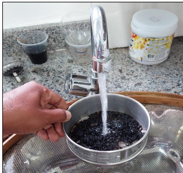
Figura 22: Lavagem do carvão após a pirólise impregnado com a solução ativante.
