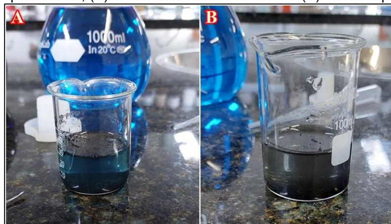
Figura 63: Após 55 min, (A) carvão ativado-fisicamente e (B) ativado-quimicamente.
