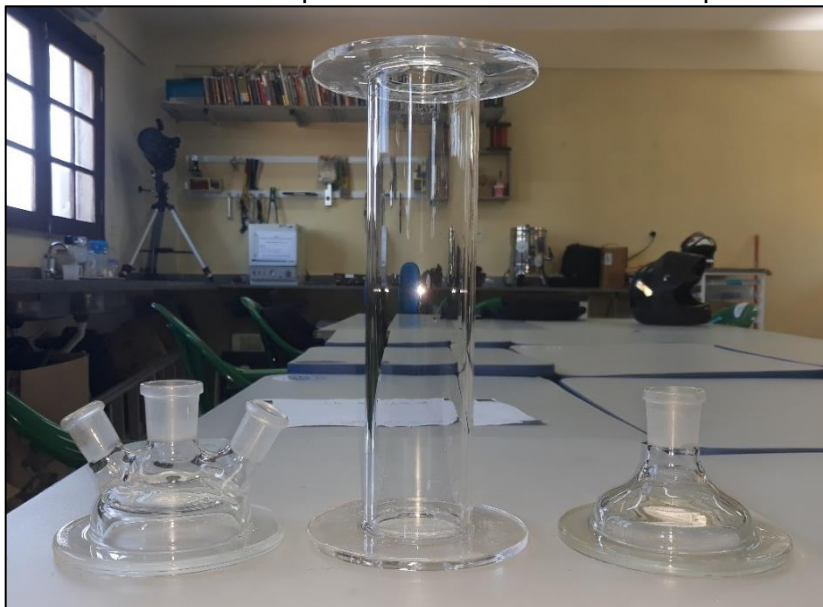
Figura 04: Reator de vidro com tampas inferior com um saída e superior com três saídas.
