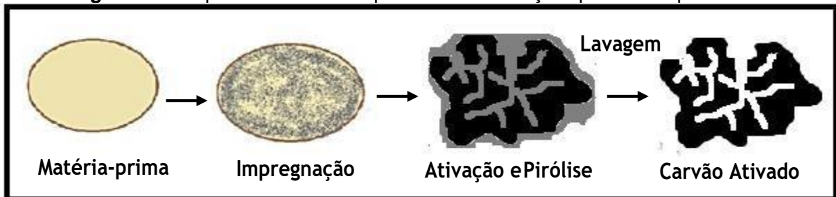
Figura 04: Etapas envolvidas no processo de ativação química do precursor.
