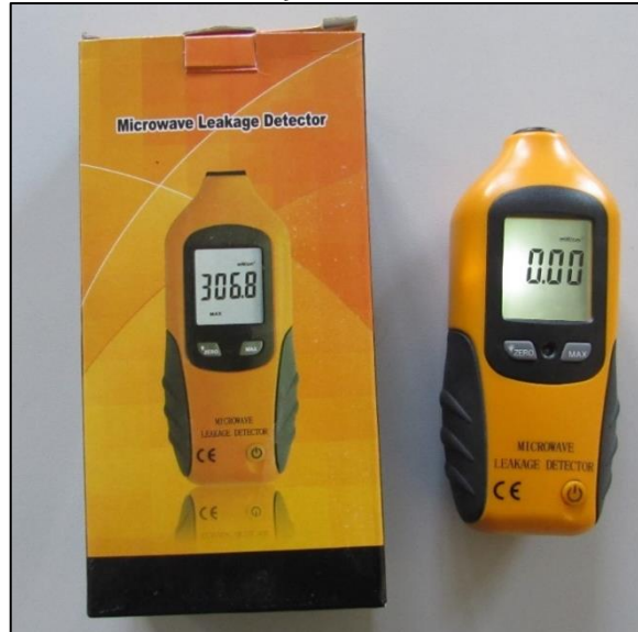
Figura 15: Aparelho medidor de radiação em forno micro-ondas portátil ( \text{mW/cm}^2 ).
