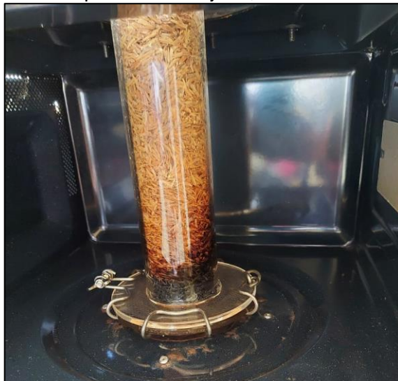
Figura 18: Atingindo a temperatura desejada, mas não houve pirólise completa.
