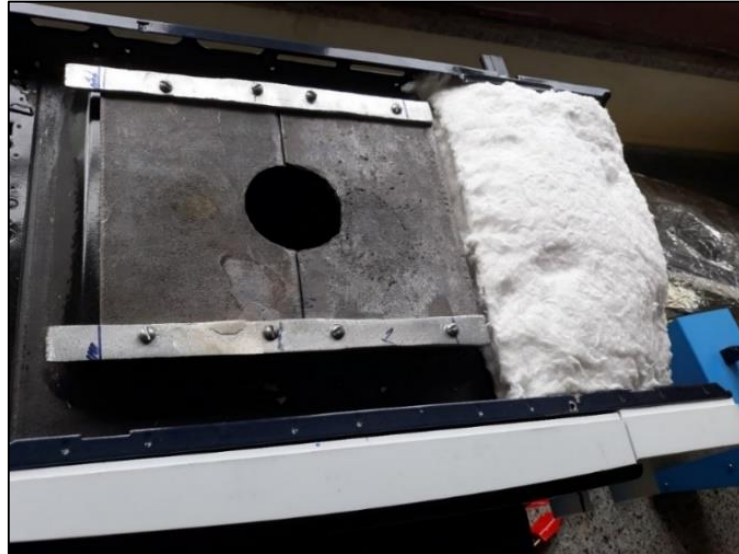
Figura 13: Placas de chumbo fixa no forno micro-ondas.
