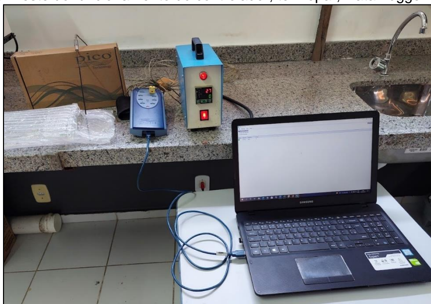
Figura 09: Teste do funcionamento do controlador, termopar, Data Logger e PicoLog.
