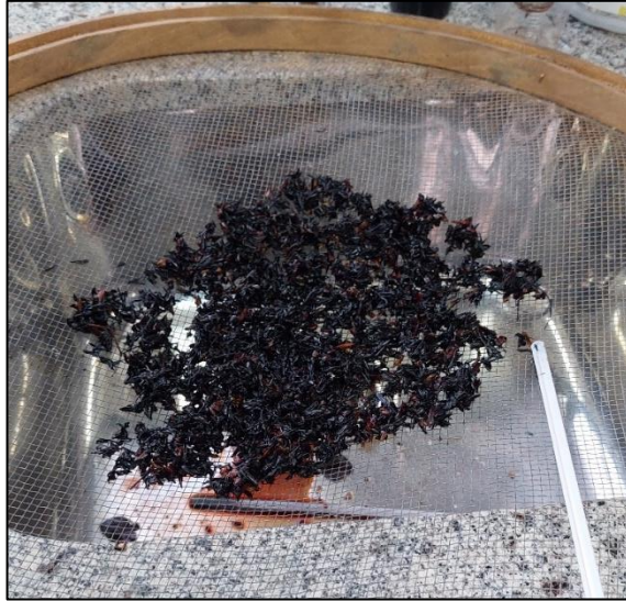
Figura 21: Secagem do carvão para prosseguir na produção de carvão ativado.
