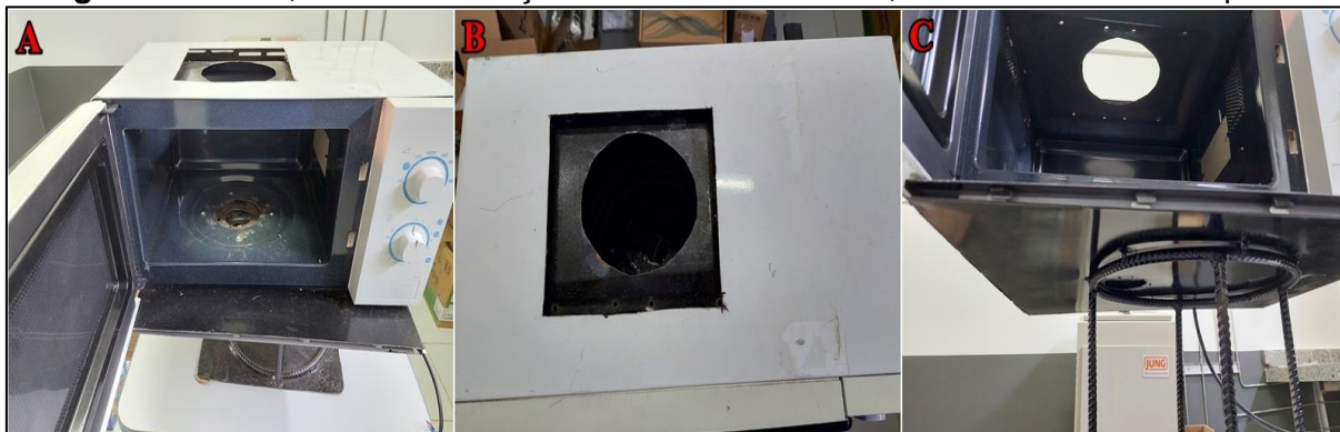
Figura 02: Em A, B e C Modificação do forno micro-ondas, cortes realizados e suporte.
