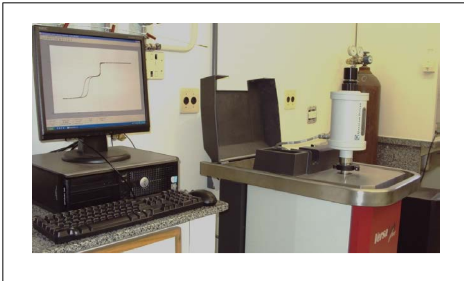
Figura 3.8: Sistema VersaLab – Quantum Design do CBPF, usado para as medidas de magnetização.
