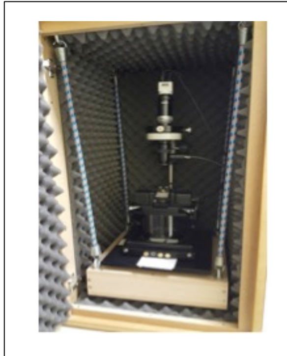
Figura 3.6: Equipamento utilizado para medições de AFM localizado no Laboratório de Raios-X da UNIPAMPA.
