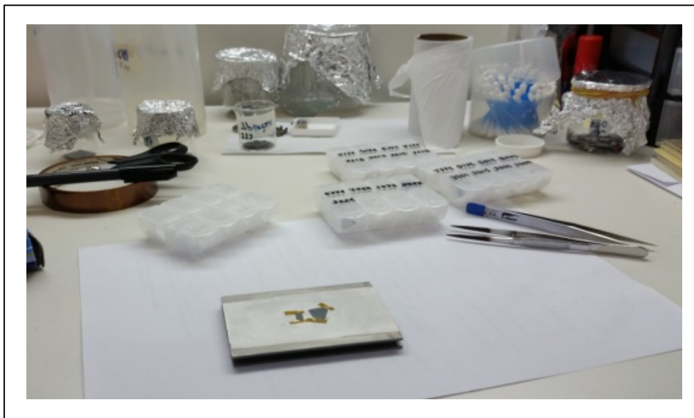
Figura 4.3: Substratos limpos e fixos com fita Kapton sobre a placa de suporte, que é encaixada no sistema de pulverização catódica.
