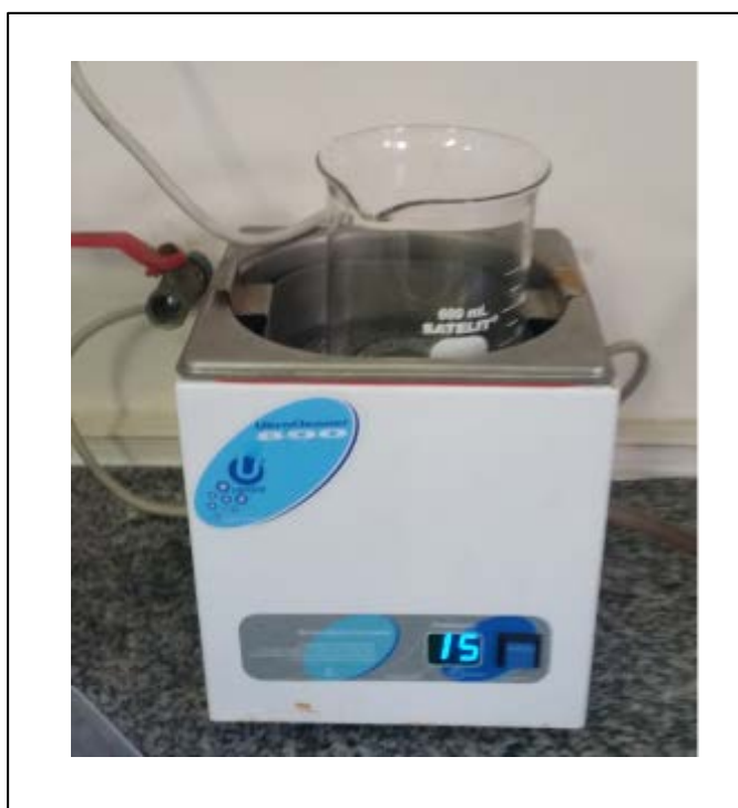
Figura 4.1: Processo de limpeza dos substratos por meio de banhos com ultrassom.
