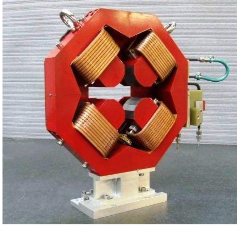
Figura 3 – Implementação experimental de um quadrupolo magnético.
