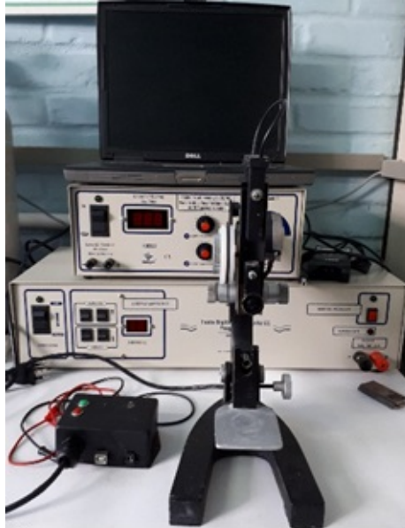
Figura 3.5 - Equipamento utilizado na técnica dip-coating.
