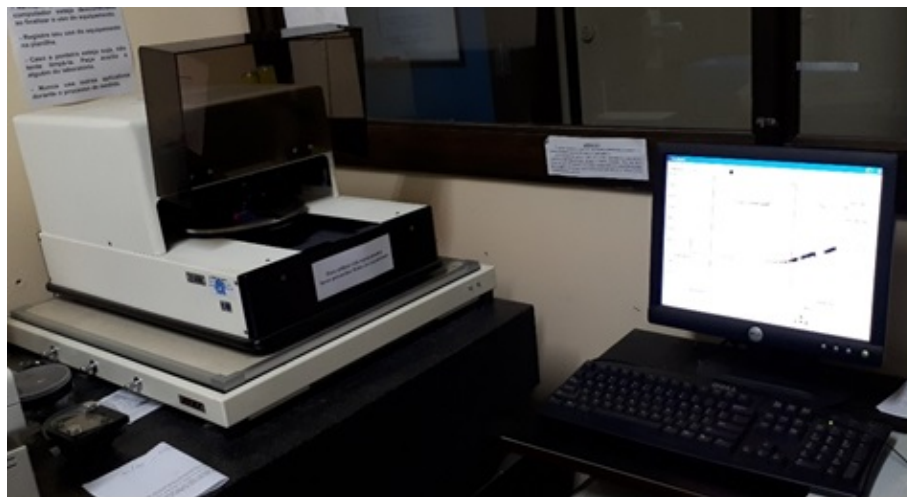
Figura 3.18 - Perfilômetro da marca AMBÍOS TECHNOLOGY XP-2 pertencente a Universidade Federal do Rio Grande do Sul - UFRGS.
