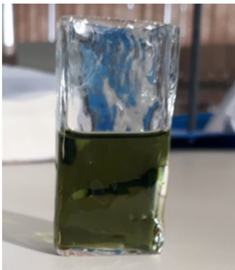
Figura 3.2 - Solução de vanadato de bismuto sintetizada pelo método MOD.
