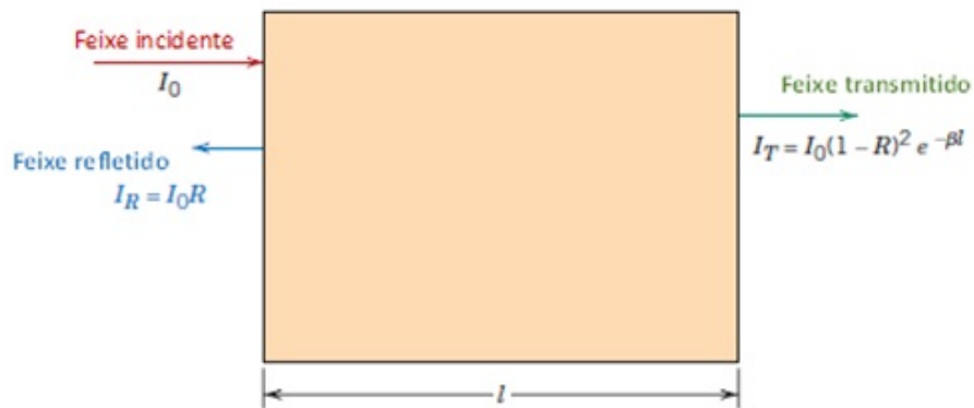
Figura 2.8 - Representação da transmissão de luz em um meio transparente, onde há reflexo nas faces frontal e posterior, assim como a absorção no meio do material.
