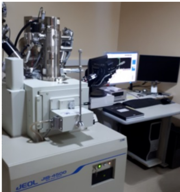
Figura 3.15 - Microscópio eletrônico de varredura da marca JEOL - JIB4500, pertencente a Universidade Federal do Rio Grande do Sul - UFRGS.
