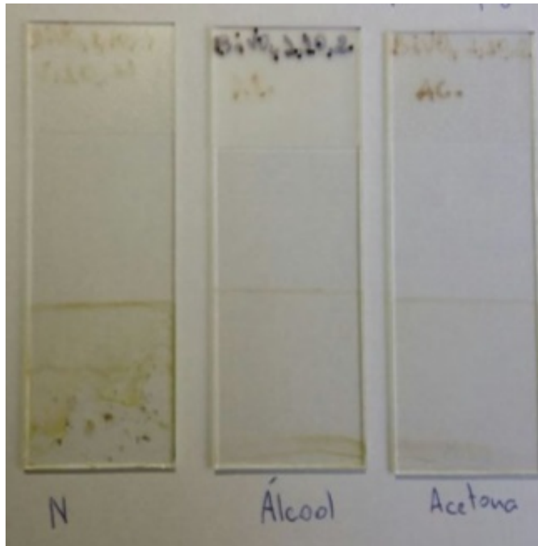
Figura 3.7 - Tratamento de limpeza das lâminas variando os agentes de limpeza.
