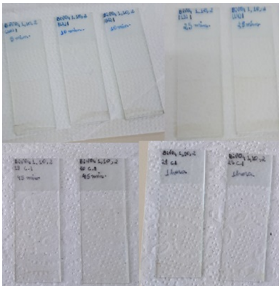
Figura 3.11 - Amostras com uma deposição de \text{BiVO}_4 variando o tempo no forno em 5, 10, 25, 45 minutos e 1 hora, respectivamente.
