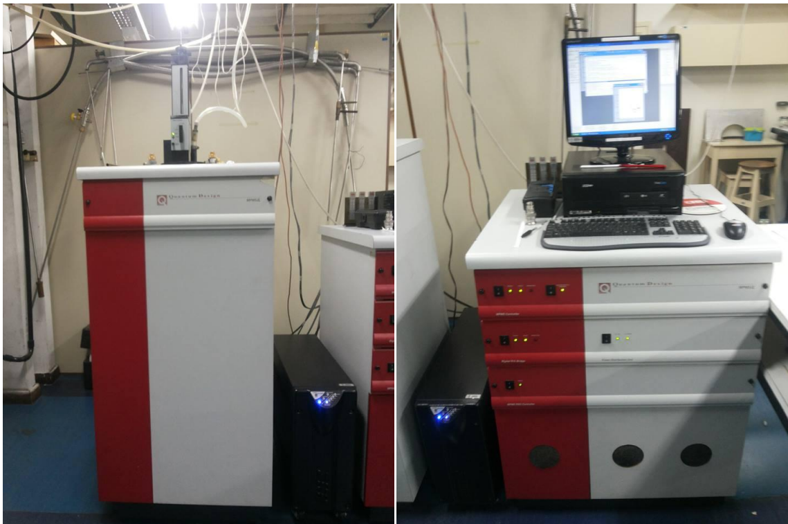
Fig. 3.6 - Magnetômetro SQUID (“Superconductor Quantum Interference Device”), Laboratório de Supercondutividade e Magnetismo da UFRGS. (Foto por: Moisés Leonardi Almeida)
