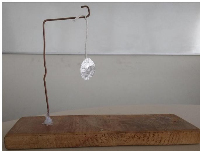
Figura 1: Pêndulo eletrostático. Fonte: A autora.
