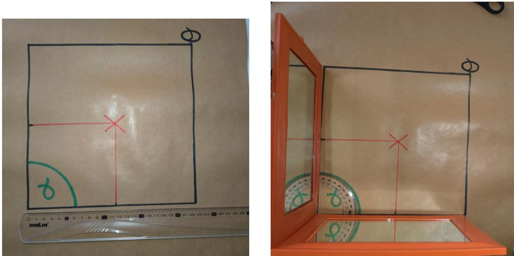
Figura 1: Medidas dos espelhos, posição do transferidor e do observador/ Espelhos e transferidor posicionados.
