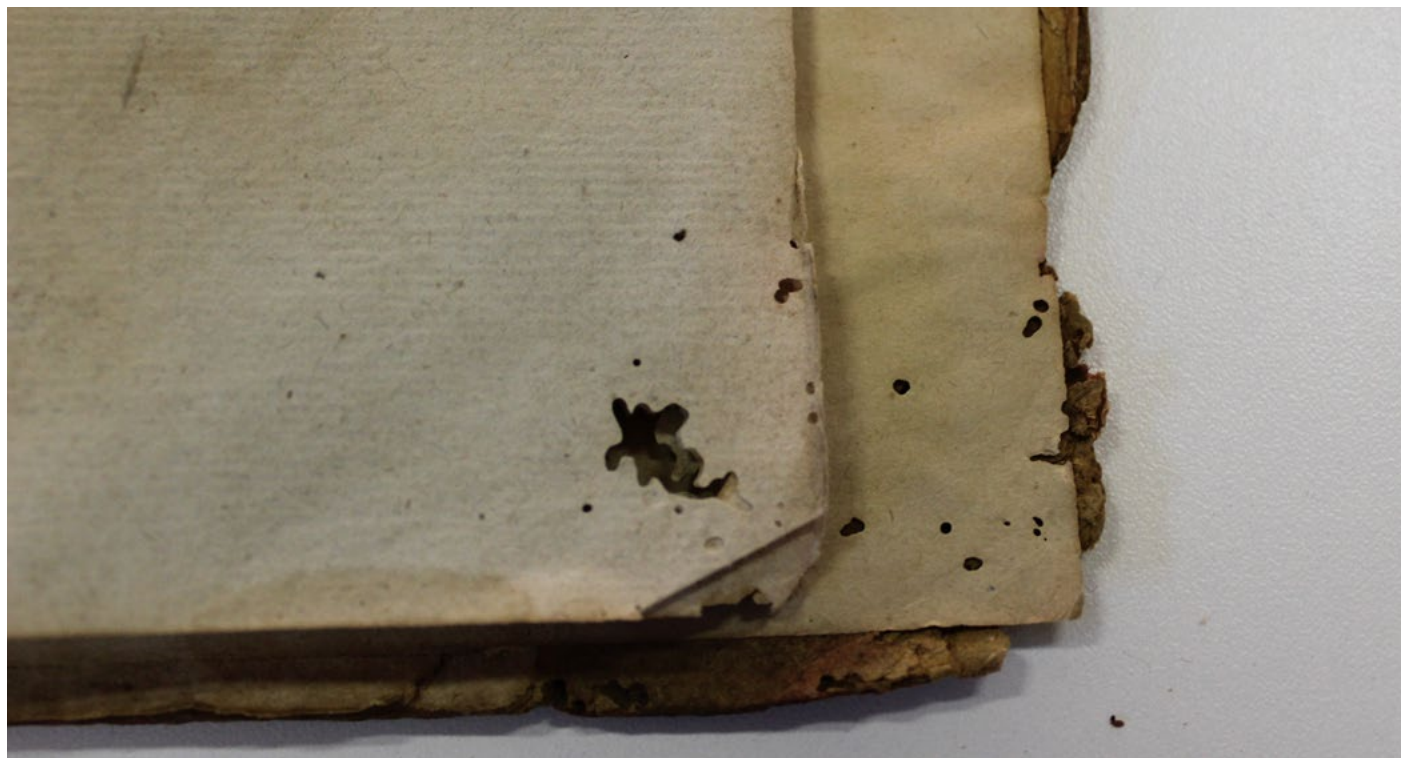
Figura 4: Perfurações no suporte por ataque de insetos xilófagos Fonte: autoria própria, 2021.
