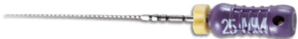
Figura 4. Lima C-Pilot exibindo, no cabo, o valor do comprimento do corpo do instrumento (25 mm), bem como tope de silicone e anéis de calibração no intermediário (VDW, 2014).
