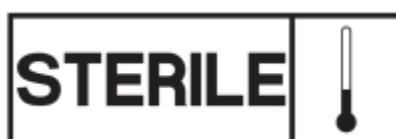
Figura 6. Símbolo ISO que indica que o dispositivo é fornecido estéril e foi esterilizado por vapor ou calor seco. Fonte: https://www.iso.org/obp/ui/#iso:grs:7000:2503 .
