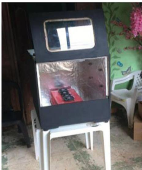
Figura 11. Protótipo de Estufa de Circulação Forçada de Ar para determinação do teor de matéria seca de tecidos vegetais. Tomé-Açu, Pará, 2019.
