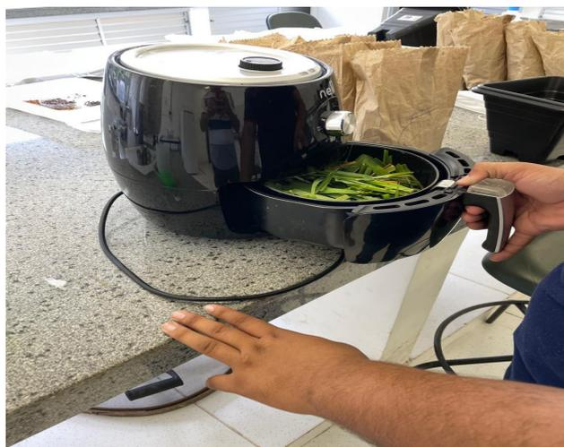
Figura 12. Secagem de gramíneas forrageiras tropicais em equipamento de aquecimento por ar *Air Fryer* para determinação do teor de matéria seca. Tomé-Açu, Pará, 2022.
