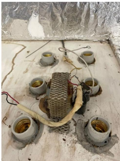
Figura 5. Bocais utilizados no protótipo da Estufa de Circulação Forçada de Ar para secagem de material vegetal. Tomé-Açu, Pará, 2019.
