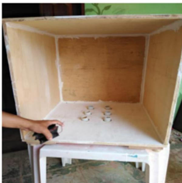
Figura 2. Construção do equipamento empregando a massa corrida e instalação dos bocais no centro do protótipo da Estufa de Circulação Forçada de Ar para secagem de material vegetal. Tomé-Açu, Pará, 2019.
