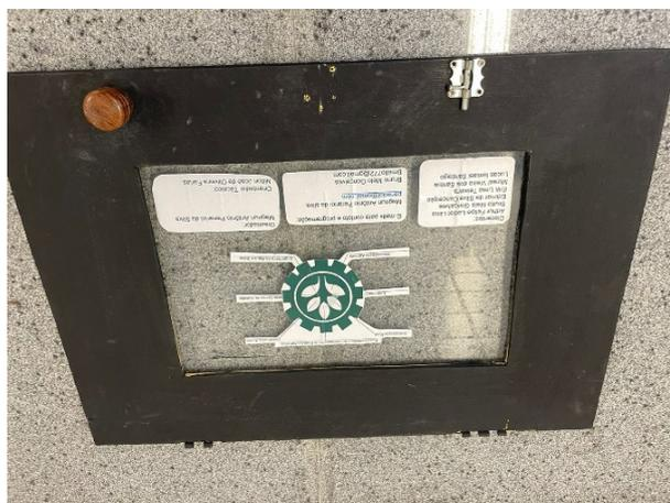
Figura 8. Porta com vidro, maçaneta e trinco de um protótipo da Estufa de Circulação Forçada de Ar. Tomé-Açu, Pará, 2019.
