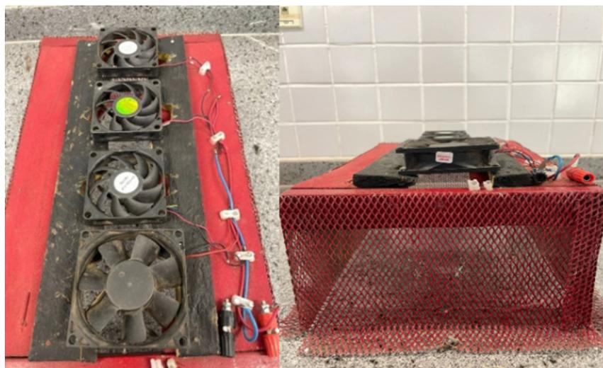
Figura 9. Estrutura de sustentação dos ventiladores para renovação do ar interno de uma Estufa de Circulação Forçada de Ar. Tomé-Açu, Pará, 2019.
