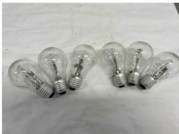
Figura 6. Lâmpadas incandescentes de 60 watts usadas para a elevação da temperatura no interior da câmara de secagem do protótipo da Estufa de Circulação Forçada de Ar. Tomé-Açu, Pará, 2019.
