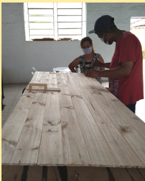
Figura 30. O dispositivo de porta isolante . Acervo dos autores, 2021.
