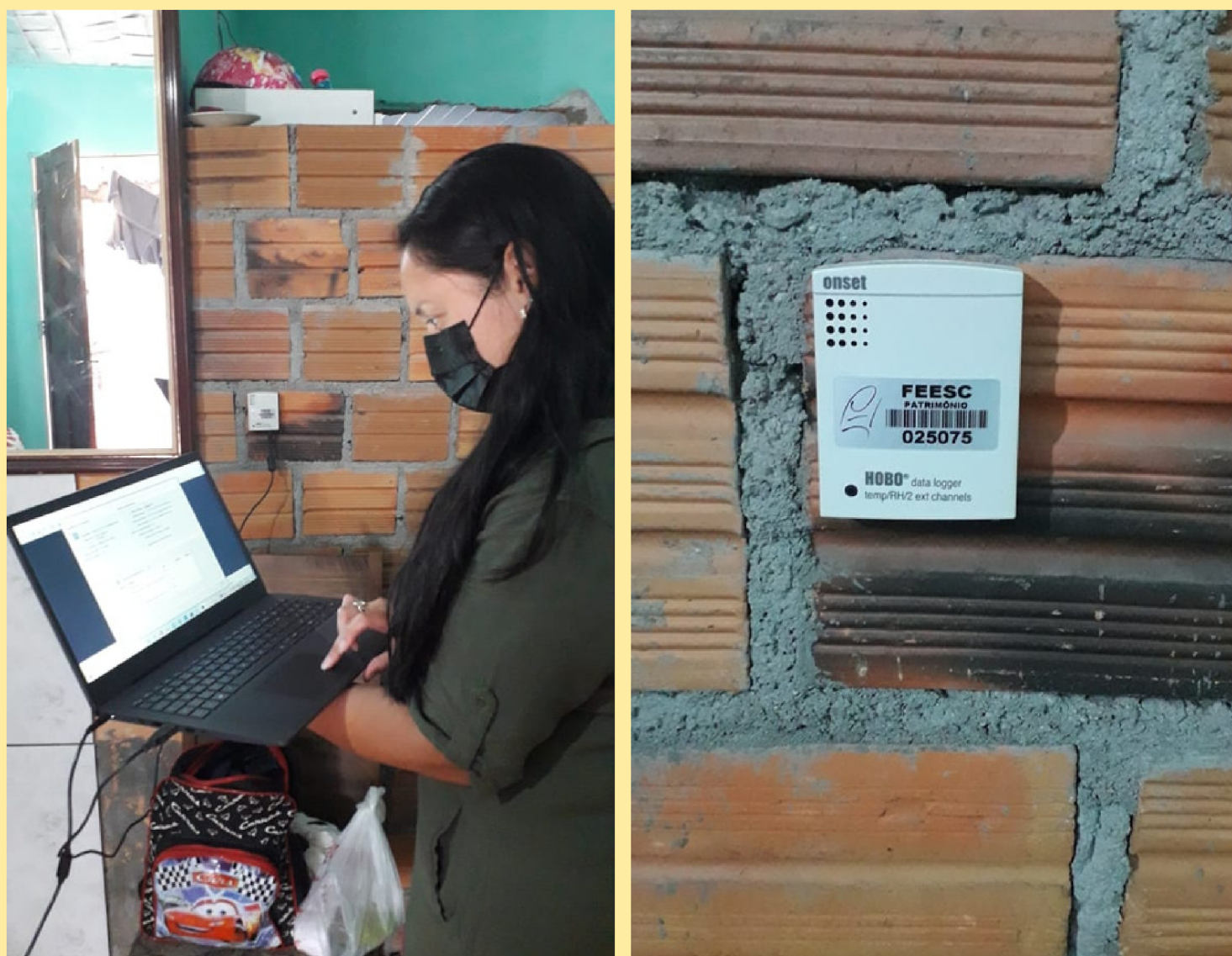
Figura 32. Aferição das temperaturas internas de uma das habitações. Acervo dos autores, 2022.
