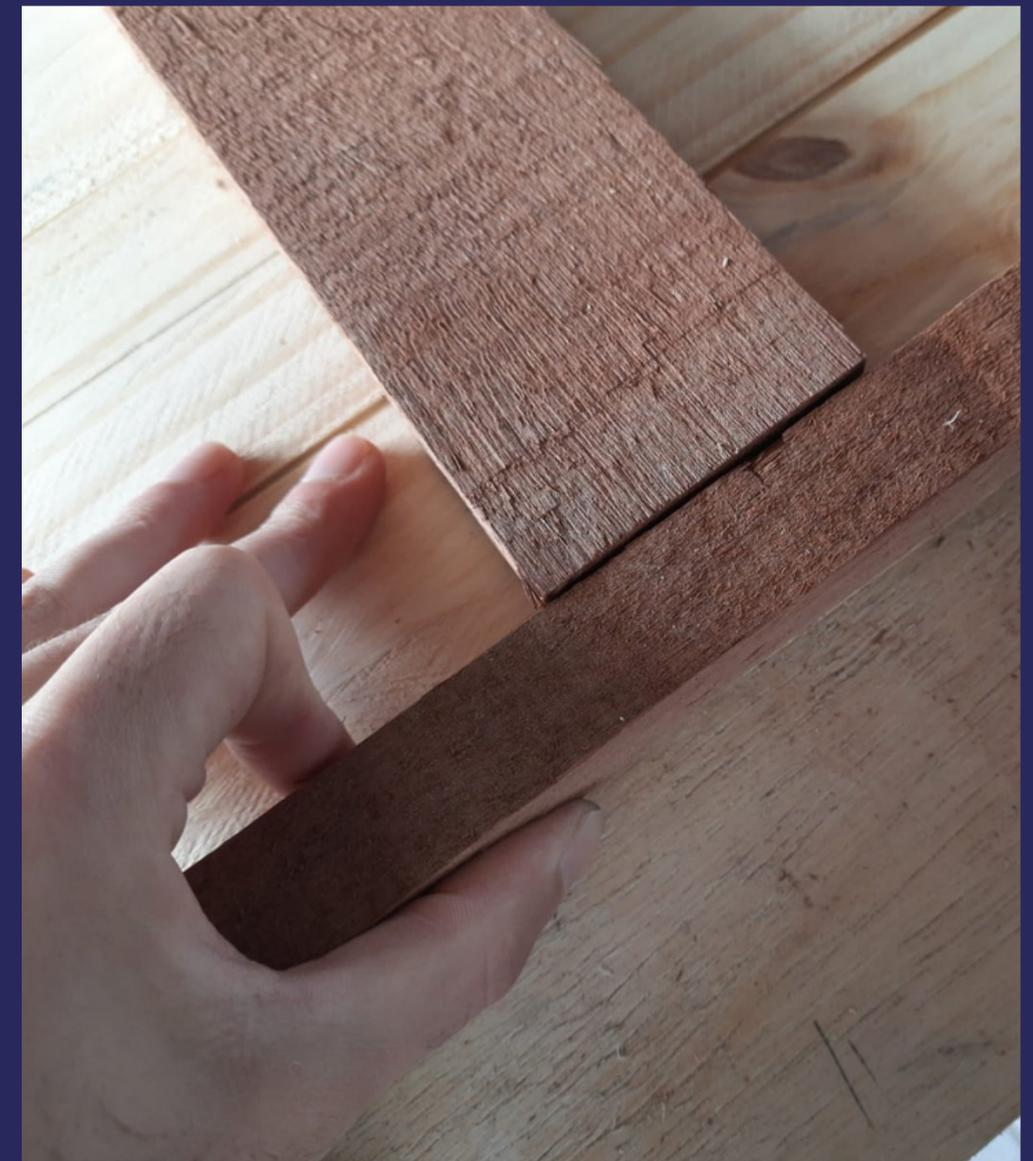
As travessas são importantes para a estruturação da porta. Por isso traçamos um "Z" o qual serve de apoio para fixação das régua de lambri.
