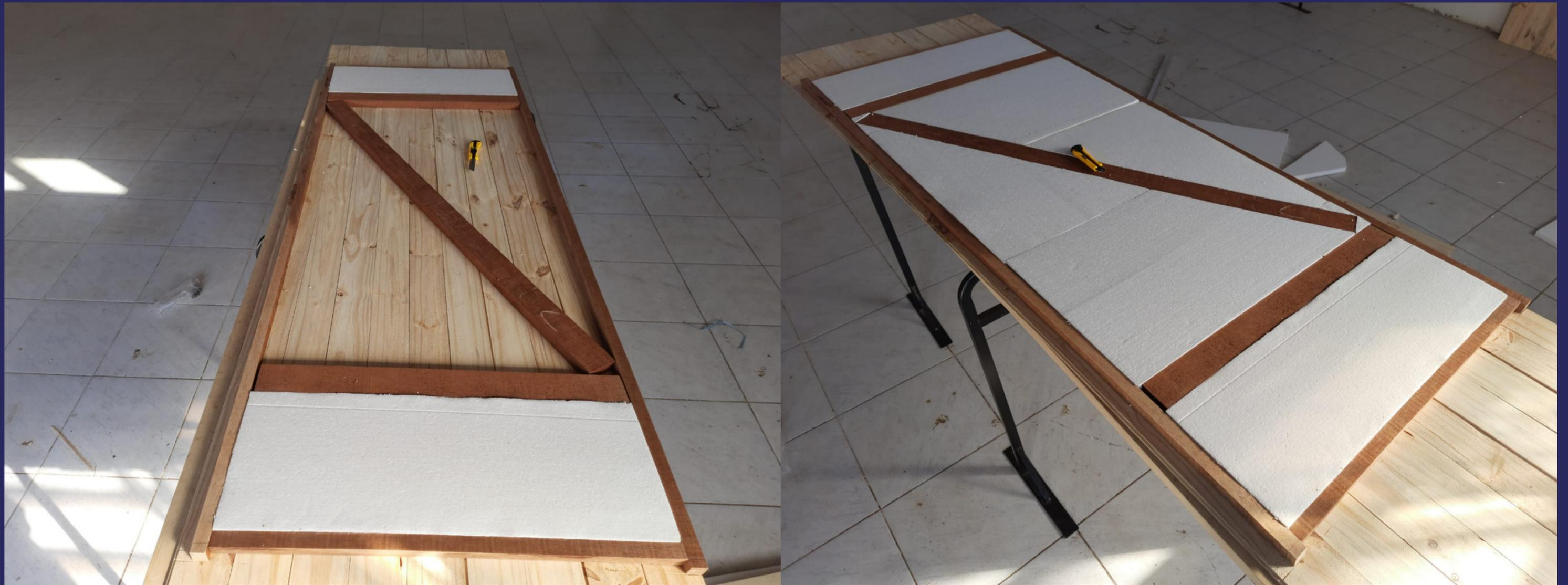
A porta é lixada e impermeabilizada com jimo cupim e tinta esmalte.
