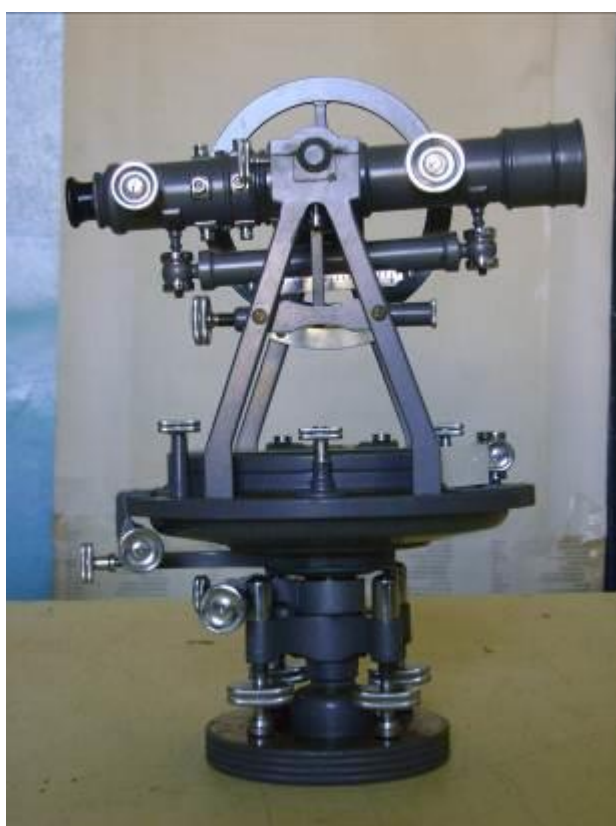
Figura 10 - Possível Teodolito W. & LE Gurley, provavelmente do catálogo de 1921. Fonte: Caroline Peixoto Pires, maio. 2011
