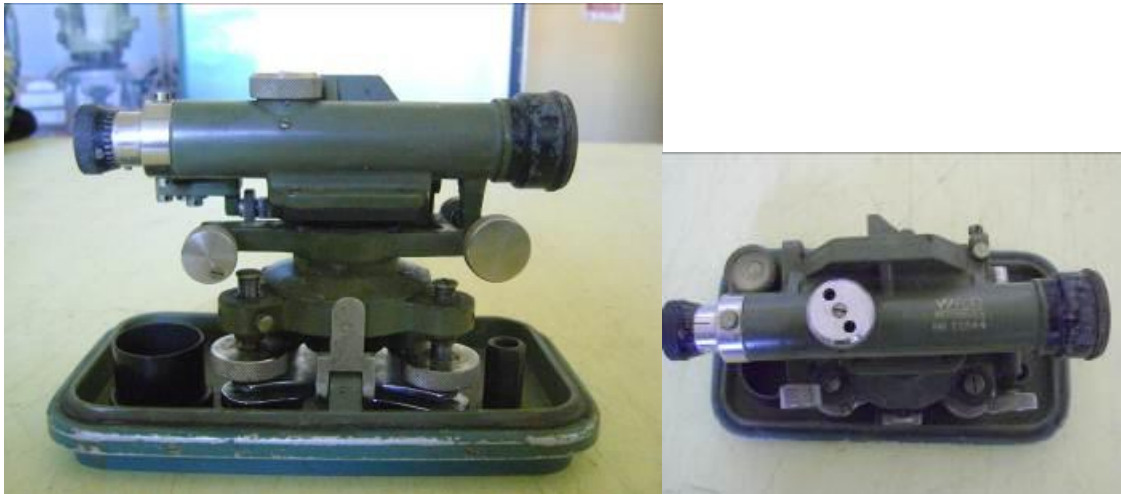
Figura11- Wild Heerbrugg Level N2, fabricado entre 1939 a 1969. Fonte: Caroline Peixoto Pires, maio. 2011.
