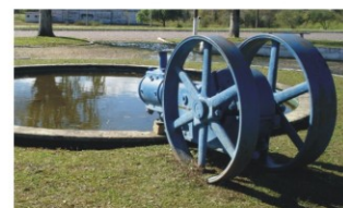
5- Bomba de Drenagem utilizada na mina do Seival.
