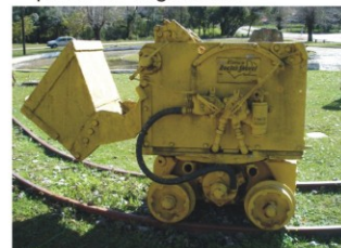
2- Carregadeira Pneumática utilizada para carregar o minério até as vagonetas.
