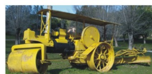
6- Patrola ou Rolo Compressor, movido à vapor, utilizado para compactar o solo, tendo em anexo uma plaina.
