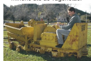
3- Locomotiva à diesel, utilizada no período dos Belgas para puxar as vagonetas.
