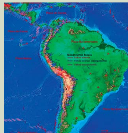
Figura 4 – Infomapa de parte da Placa Sul-Americana, algumas das placas tectônicas vizinhas, os vetores de deslocamento (setas vermelhas) das placas e regimes de tensões dos abalos sísmicos ocorridos no ano de 2004. Fonte: jules.unavco.org/Voyager/Docs/Earth
