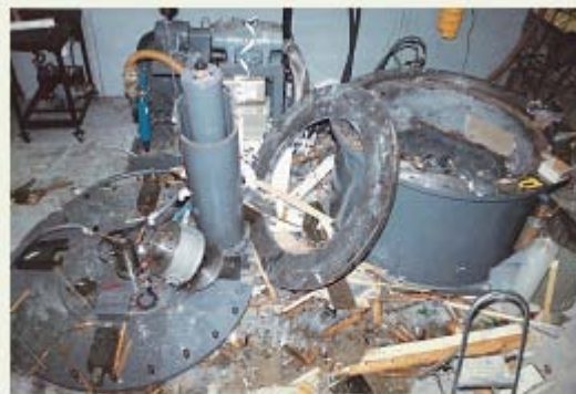
Figura 10-15 Parte da destruição causada pela explosão de um disco de aço em alta rotação. (Cortesia de Test Devices, Inc)
