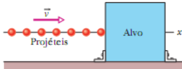
Figura 9-10 Uma série de projéteis, todos com o mesmo momento linear, colide com um alvo fixo. A força média F_{\text{med}} exercida sobre o alvo aponta para a direita e tem um módulo que depende da taxa com a qual os projéteis colidem com o alvo ou, alternativamente, da taxa com a qual a massa colide com o alvo.
