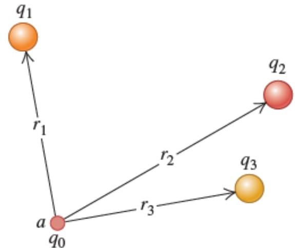
Energia potencial elétrica da carga puntiforme  $q_0$  e o conjunto de cargas  $q_1, q_2, q_3, \dots$
