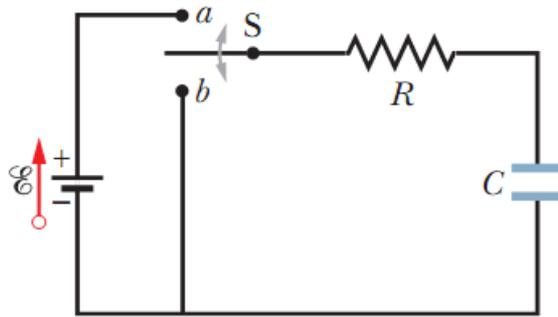
**Figura 27-15** Quando a chave S é colocada na posição *a*, o capacitor é *carregado* através do resistor. Mais tarde, quando a chave é colocada na posição *b*, o capacitor é *descarregado* através do resistor.
