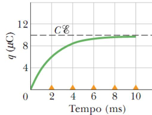
$$\mathcal{E} - iR - \frac{q}{C} = 0 \quad i = \frac{dq}{dt} \quad \longrightarrow \quad R \frac{dq}{dt} + \frac{q}{C} = \mathcal{E} \quad (\text{equação de carga})$$
