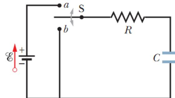
**Figura 27-15** Quando a chave  $S$  é colocada na posição  $a$ , o capacitor é *carregado* através do resistor. Mais tarde, quando a chave é colocada na posição  $b$ , o capacitor é *descarregado* através do resistor.
