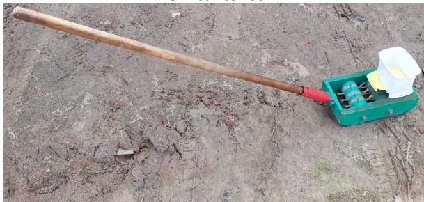
Figura 5 - Equipamento adaptado para realizar adubação/calagem e incorporação no solo em canteiros
