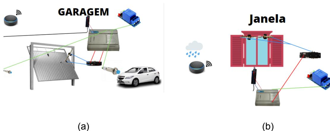
Nas janelas a assistente virtual detecta a possibilidade de chuva e fecha as janelas automaticamente, acionadas pelos atuadores pneumáticos, também pode ser controlada por voz pelo comando “janela”, onde é aberta ou fechada dependendo do comando que antecede. Em paralelo tem a abertura manual, a janela utiliza o sistema de abertura semelhante à abertura da porta de ônibus.
