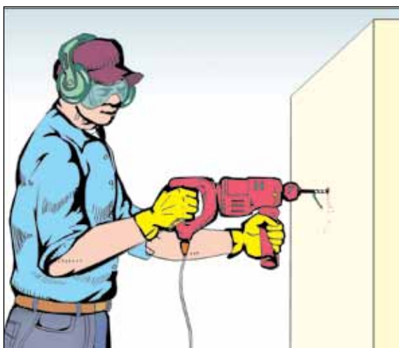
Figura 18c. (i) e (ii) Preensão constante de ferramentas mecânicas podem ajudar a reduzir a força necessária de operação.
