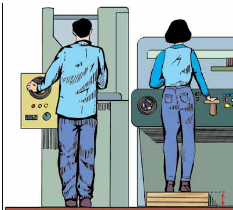
Figura 52a. Utilize plataformas sob os pés para os trabalhadores mais baixos com o objetivo de assegurar uma altura de trabalho apropriada, próximo ao nível dos cotovelos.
