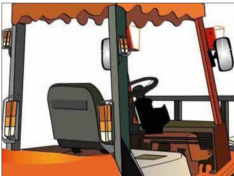
Figura 63b. Providencie espelhos e luminárias em posições adequadas para permitir ampla visibilidade em várias situações de operação.
