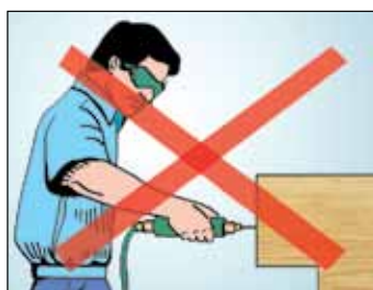
Figura 24e. Uma ferramenta deve ser utilizada (como acima) em uma superfície horizontal na altura do cotovelo, ou (como abaixo) em uma superfície vertical acima da altura da junta. Suspender a ferramenta pode ajudar a conseguir uma posição melhor para segurar.
