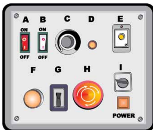
Figura 34b. Exemplos para tornar os controles diferentes mais fáceis de distinguir uns dos outros, alterando suas formas e cores.
