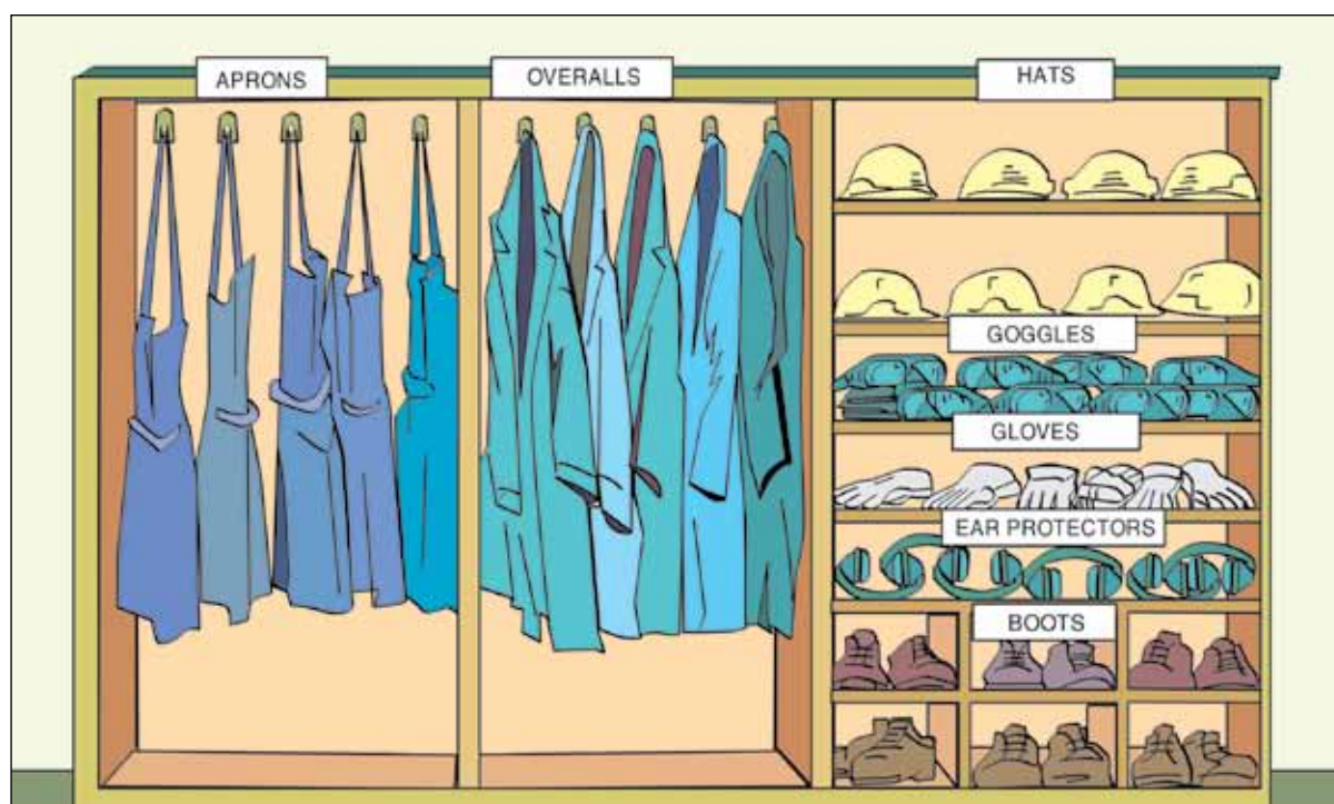
Figura 105b. Certifique-se de que o acesso ao equipamento de proteção pessoal e seu inventário é fácil para os trabalhadores e mantenha o local onde ele fica guardado em boa ordem. Utilize armários com portas onde for possível como outro meio de manter o equipamento de proteção pessoal limpo e arrumado.
