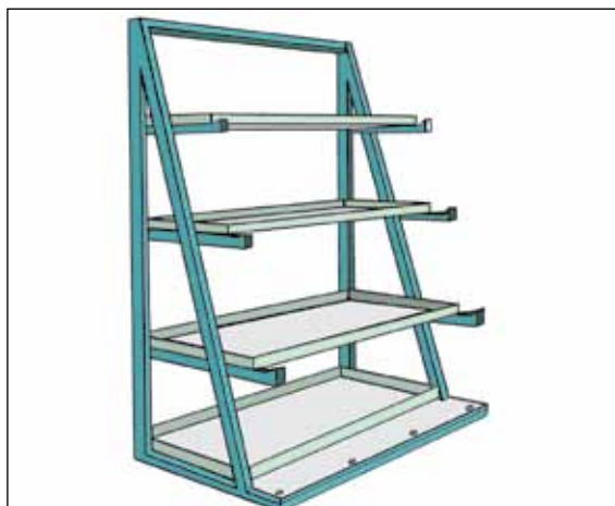
Figura 8c. Conjunto de prateleiras vertical. As varas e barras metálicas de diferentes perfis podem ser armazenadas de modo eficaz em uma área limitada ou perto do trabalho. As prateleiras do tipo bandeja proporcionam um lugar para as peças pequenas.
