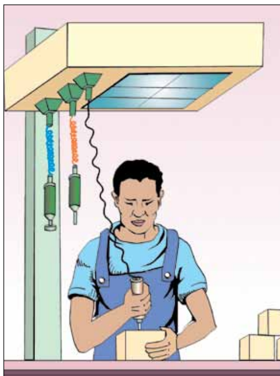
Figura 20c. Providencie uma estrutura especial que fique acima do trabalhador, na qual possam ser suspensas as ferramentas por meio de mecanismos de molas ou elásticos.
