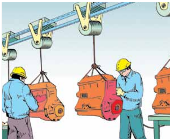
Figura 10a. O transporte mecânico de materiais pode eliminar o trabalho manual e, ao mesmo tempo, melhorar a postura e a altura do trabalho.
