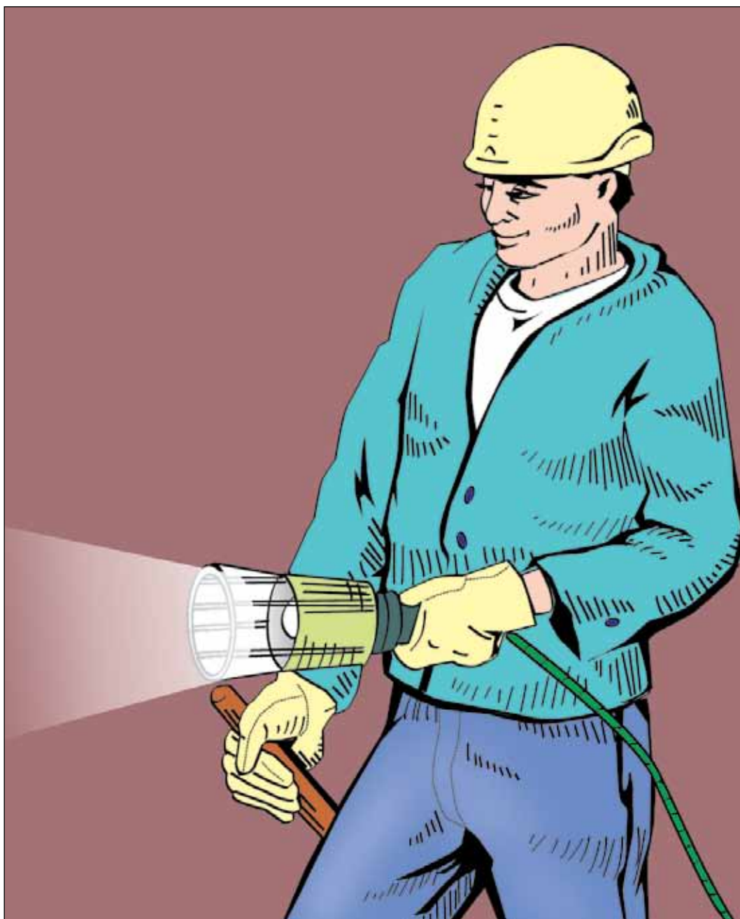
Figura 89. Utilize luminárias de mão que sejam bem isoladas e tenham acessórios firmes e cabos seguros.
