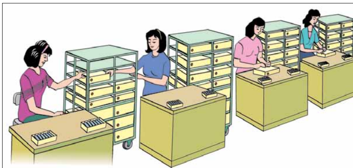
Figura 119a. Linha de montagem com estoques intermediários.
