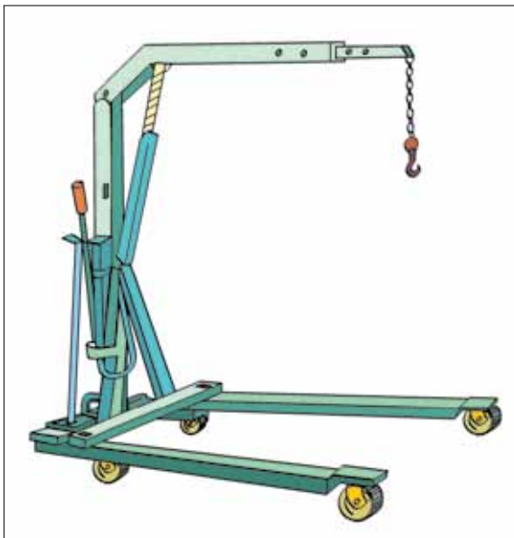
Figura 9b. Um dispositivo mecânico acionado manualmente para levantar peças de fundição até a altura de trabalho.
