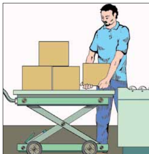
Figura 13d. Mova os materiais ao longo de superfícies da mesma altura.
