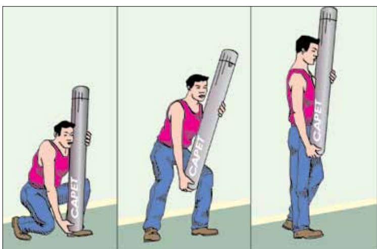
Figura 15b. Um grande objeto pesado também pode ser erguido usando a força das pernas, sendo mantido o mais próximo possível do corpo.
