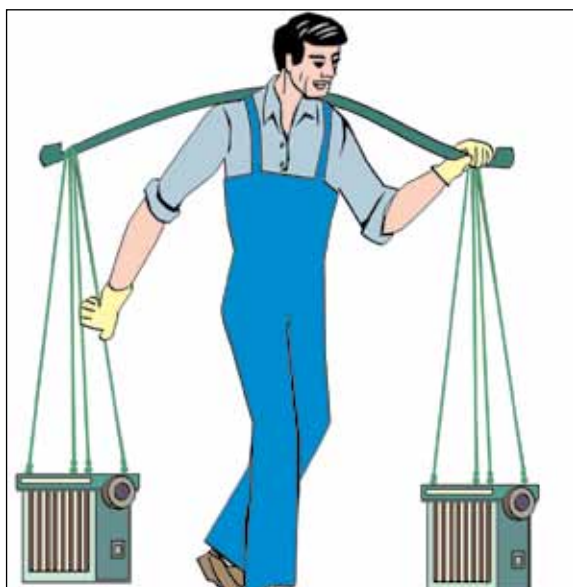
Figura 11c. Um balancim, ou outro mecanismo similar, é útil para transportar por determinada distância duas cargas separadas, ao mesmo tempo que mantém o equilíbrio e diminui o trabalho de erguer e baixar.
