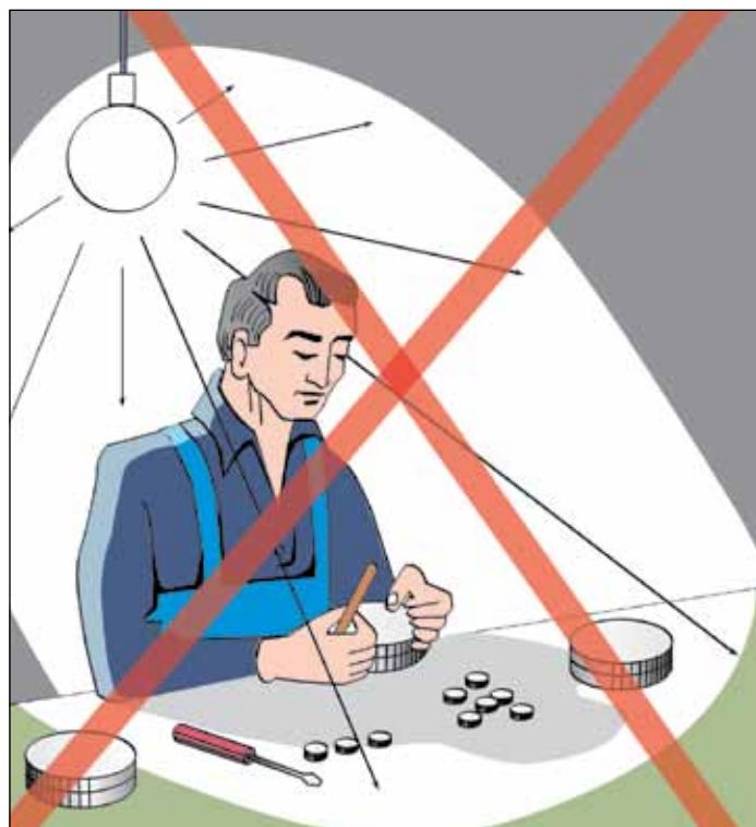
Figura 67c. As sombras escuras tornam o trabalho difícil.
