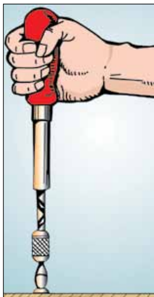
Figura 24a. Ferramentas alternativas podem ser empregadas para reduzir o estresse mecânico. Por exemplo, uma chave especial equipada com uma lingueta.
