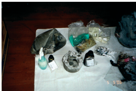
Figura 3: Recipientes com solventes utilizados na limpeza, coletados após a explosão e analisados em laboratório
