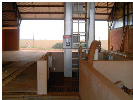
Figura 2: Elevador de grãos após o acidente, com sinalização e sistema de ventilação
