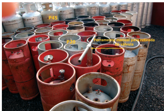
Figura 8: Botijões P20 com ferramenta manual para retirada das válvulas
