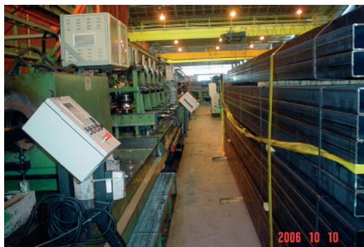
Figura 1: Local de ocorrência do acidente, setor de formação de tubos de aço carbono, ao lado da máquina formadora de tubos, equipamento em manutenção e regulagem no dia do acidente
