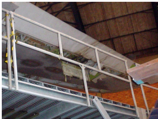
Figura 4: Vista detalhada do local de instalação, na asa direita, dos sensores pelos trabalhadores (reconstituição)
