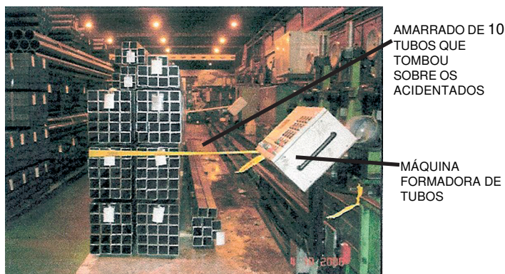
Figura 2: Cedida pela empresa, foto colhida no dia do acidente. Pode-se observar a posição do empilhamento de amarrados de tubos de aço carbono, com perfil quadrado, e sua composição
