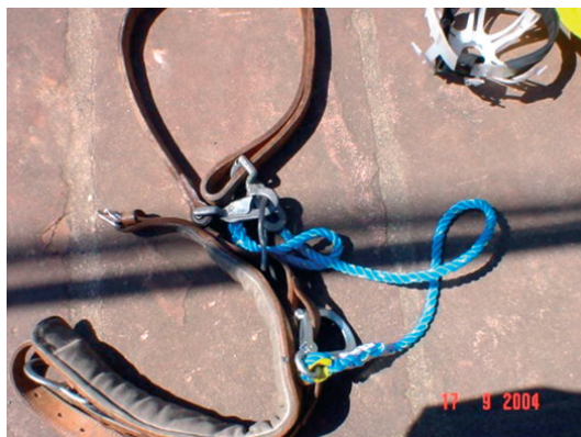
Figura 5: Cinto de segurança e talabarte utilizados pelo acidentado. Foto colhida e cedida pela empresa
