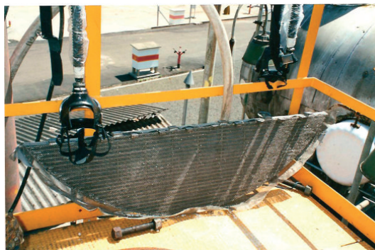
Figura 3: Segmento menor da grade, com 58,5kg em forma de meia-lua, retirado do interior do vaso
