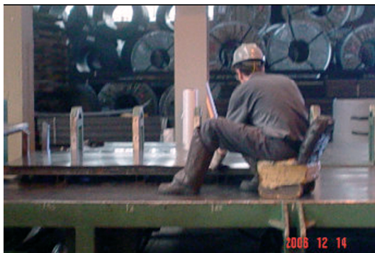
Figura 8: Outra situação encontrada na empresa, em que a presença de situações como o “homem-batente” de chapas metálicas, no setor de produção da empresa, pode comprometer os alegados esforços em busca de um ambiente sadio
