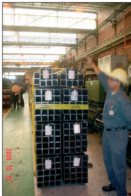
Figura 3: Reconstituição do empilhamento de amarrados de tubos de aço carbono, com perfil quadrado, realizada no dia 28.10.2006. Não foi registrada a existência de mais 2 amarrados, com 10 tubos cada
