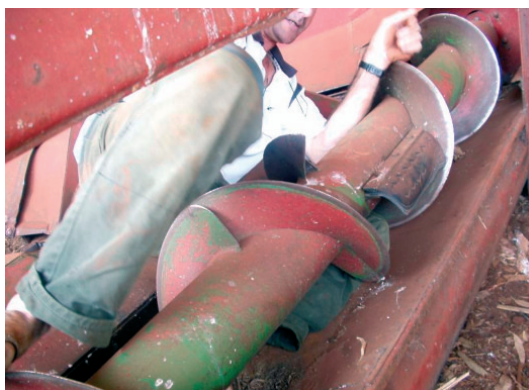
Figura 4: Detalhe da posição em que o Sr. A foi encontrado “prensado” pela rosca sem fim da plataforma de milho
