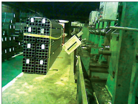
Figura 5: Vista da área onde ocorreu o acidente, coletada no dia do evento. Observe-se o processo de empilhamento dos amarrados, inclusive a existência de ripas de madeira para travamento. Igualmente, se constata a invasão da área de trabalho e a sua conseqüente exigüidade
