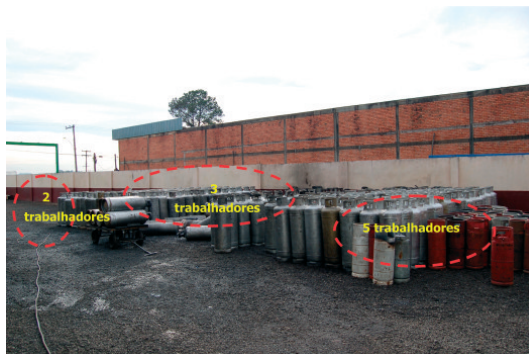
Figura 11: Área (aproximada) com GLP no ar e principalmente junto ao solo, decorrente da decantação e desgaseificação dos P45 e P20
