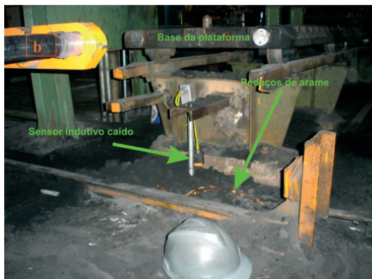
Figura 5: Foto do local colhido logo após o acidente, pelo SESMT da empresa. b- cilindro hidráulico de amortecimento
