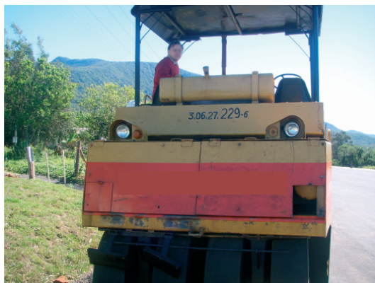
Figura 2: Vista do rolo compactador de pneus
