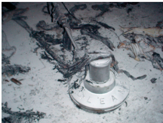
Figura 2: Enceradeira após a explosão
