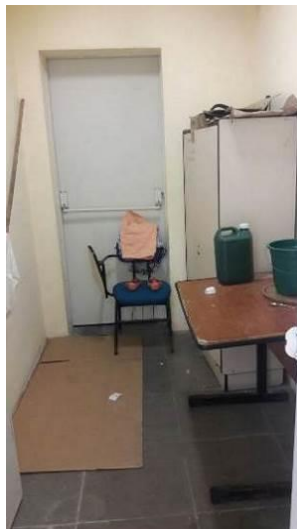
Figura 34 – Saída de Emergência utilizada como vestiário
