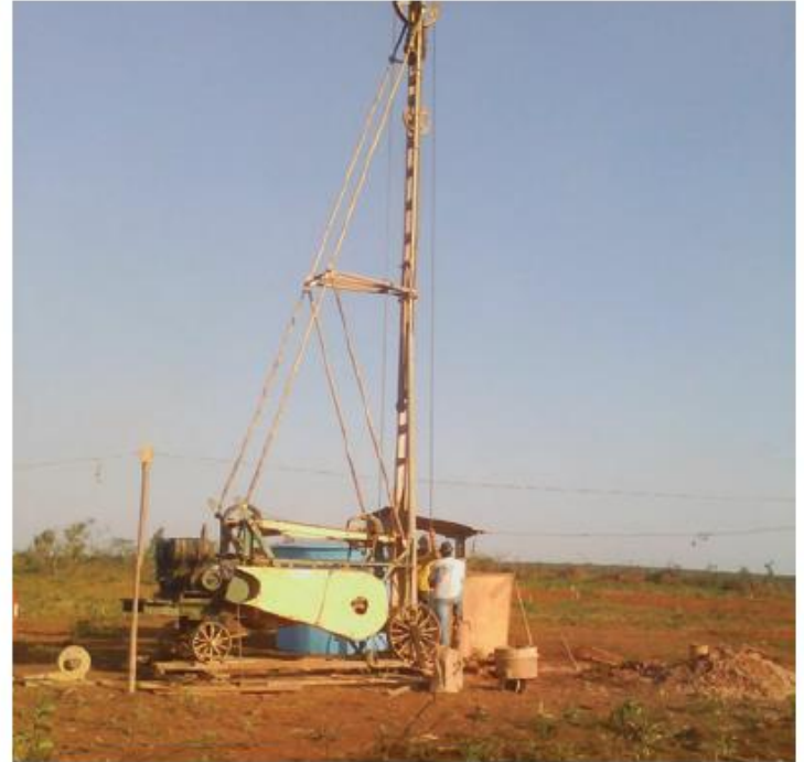
Figura 6 – Equipamento para perfuração de poço. Foto: Fabrício Bueno / Banco de Imagens da ANA.
