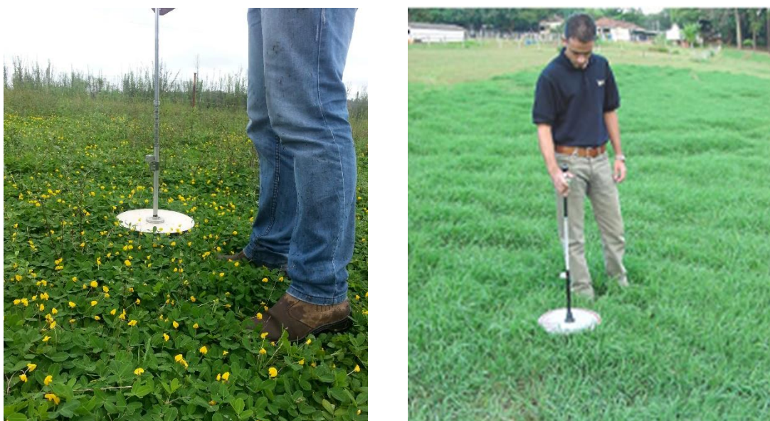
Figura 12 – Avaliação de altura e densidade realizada com o disco medidor Fonte: (KRONING, 2017; PEDREIRA, 2002).
