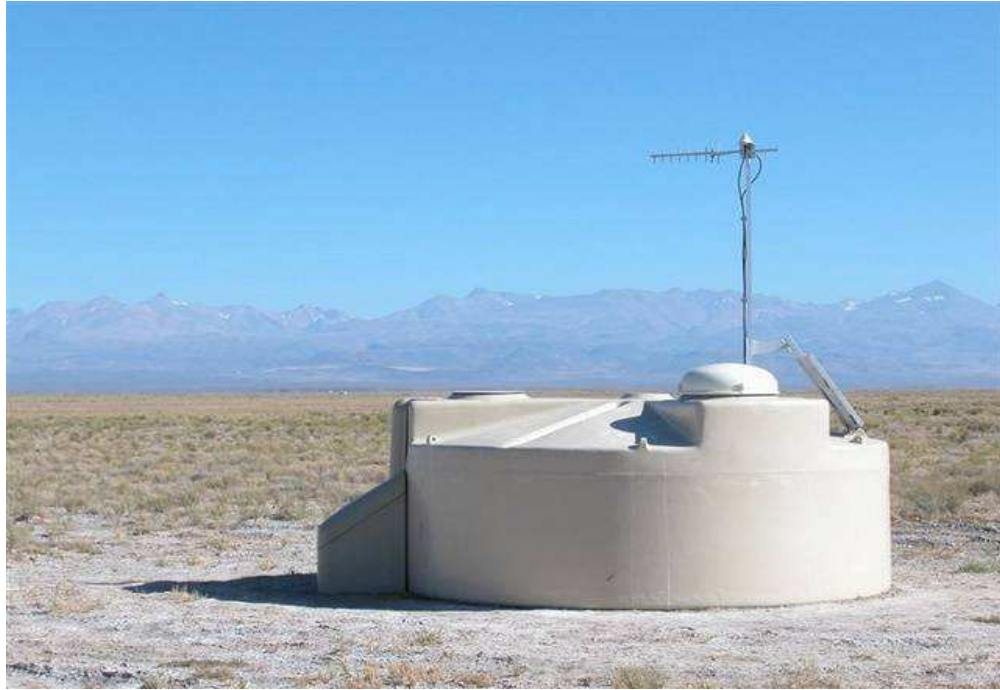
Figura 2.4: Tanque Cherenkov em funcionamento no OPA. Créditos: Colaboração Pierre Auger - http://www.auger.org/ .
