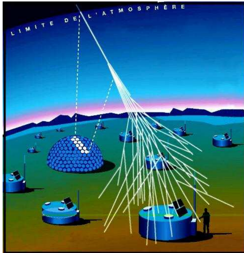
Figura 2.2: Esquema ilustrativo da complementaridade dos tanques Cherenkov e telescópios de fluorescência do OPA. Créditos: Colaboração Pierre Auger - http://www.auger.org/ .
