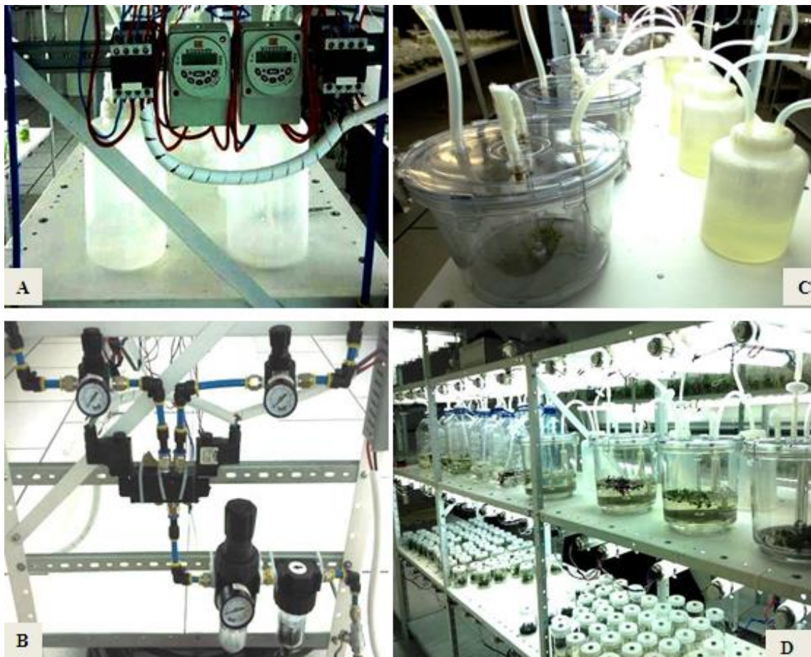
Figura 2. Biorreatores (SIT) montados na sala de crescimento no Laboratório de Cultura de Tecidos: A- Controladores de tempo; B- Válvulas, que controlam entrada e saída de ar do sistema, que estão ligadas a um compressor de ar; C- Frascos de polímero com os explantes e frascos com o meio líquido; D- Biorreatores (SIT) em funcionamento. UFPel, 2014.
