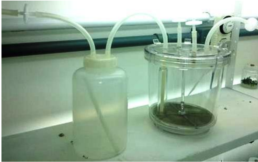
Figura 1. Modelo do biorreator com sistema de imersão temporária (SIT), utilizado para experimento com G. paniculata . UFPel, 2014.
